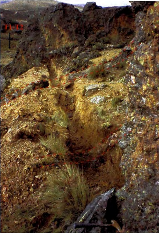
FOTO 5.1, mirando al S: Trinchera T3 con rumbo N20^{\circ}E y de aproximadamente 15 m. de largo, ubicada al S del cerro Señal Incapacha y cerca del sondaje IP-08. Se observan estructuras subparalelas ( N70^{\circ}E ) de cuarzo (sílice vuggy-sílice masiva) con gradaciones laterales a cuarzo-alunita y cuarzo-arcillas. Tienen anomalías de oro con valores de hasta 5 grAu/TM, existe anomalía en toda la trinchera.
