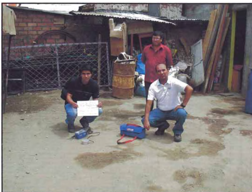
Fotografía 2.- Medición del período del suelo en el patio de la vivienda ubicada en el Jr. Libertad Cdra. 04.
