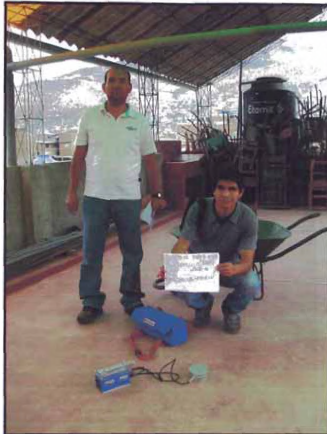
Fotografía 11.- Medición del período de la edificación ubicada en el Jr. Bolívar N° 326.
