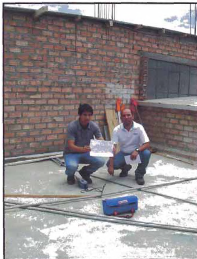
Fotografía 12.- Medición del período de la edificación ubicada en el Jr. Damaso Beraun N° 880.
