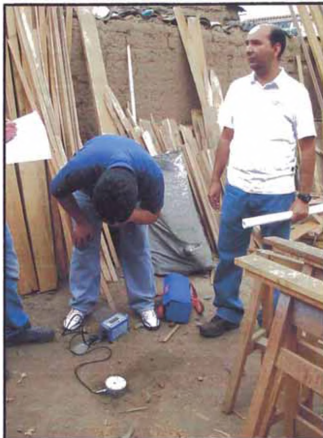
Fotografía 1.- Orientación y ubicación del sensor.
