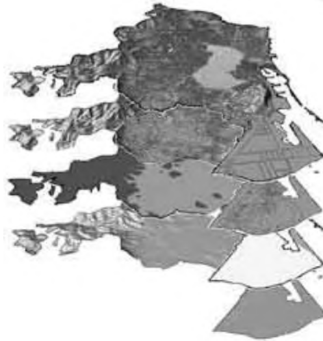
Figura 4.1.- Ejemplo de representación de información correspondiente a un área geográfica con diferentes temas o mapas (Mena et al, 2001). En la figura se muestra de abajo hacia arriba los datos correspondientes a la topografía, tipo de suelo, datos de microzonificación e información catastral.
