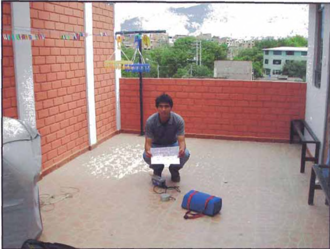
Fotografía 15.- Medición del periodo de la edificación ubicada en la Av. Malecón A. Robles N° 567.
