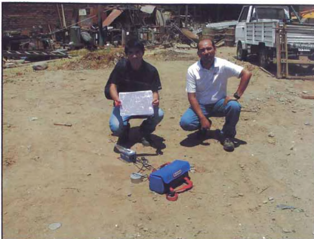
Fotografía 3.- Medición del período del suelo en una cochera ubicada en el Jr. Junín Cdra. 04
