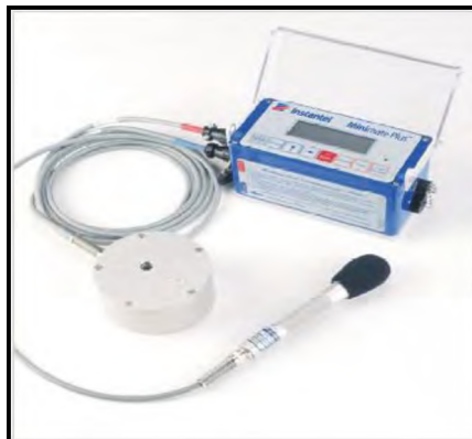
Figura 6.19.- Equipo Minimate Plus utilizado para el ensayo de microtrepidaciones. Se puede observar el geófono triaxial y el micrófono de sobrepresión.
