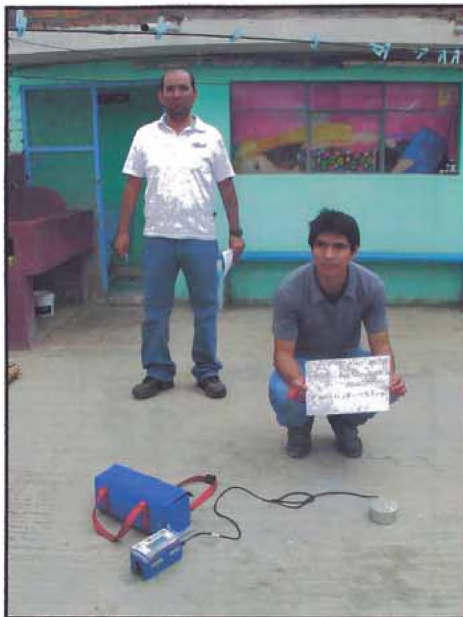
Fotografía 13.- Medición del período de la edificación ubicada en el Jr. Libertad N° 430.
