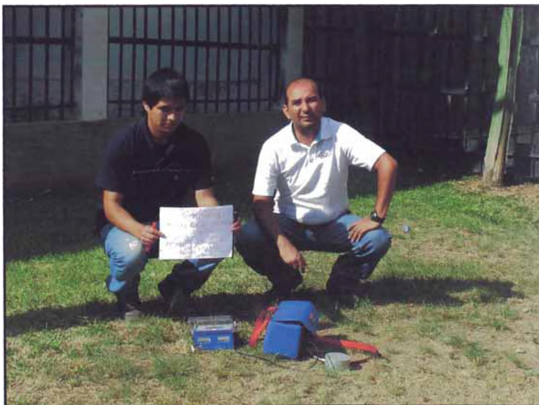
Fotografía 4.- Medición del período del suelo en el jardín de la vivienda ubicada en la Av. Malecón A. Robles Cdra. 04.
