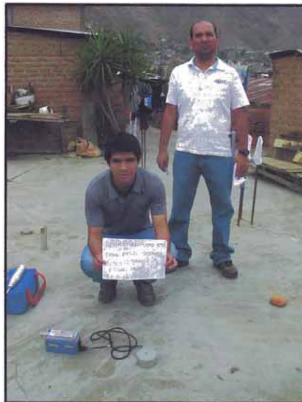
Fotografía 10.- Medición del período de la edificación ubicada en el Jr. Hermilio Valdizan N° 376.
