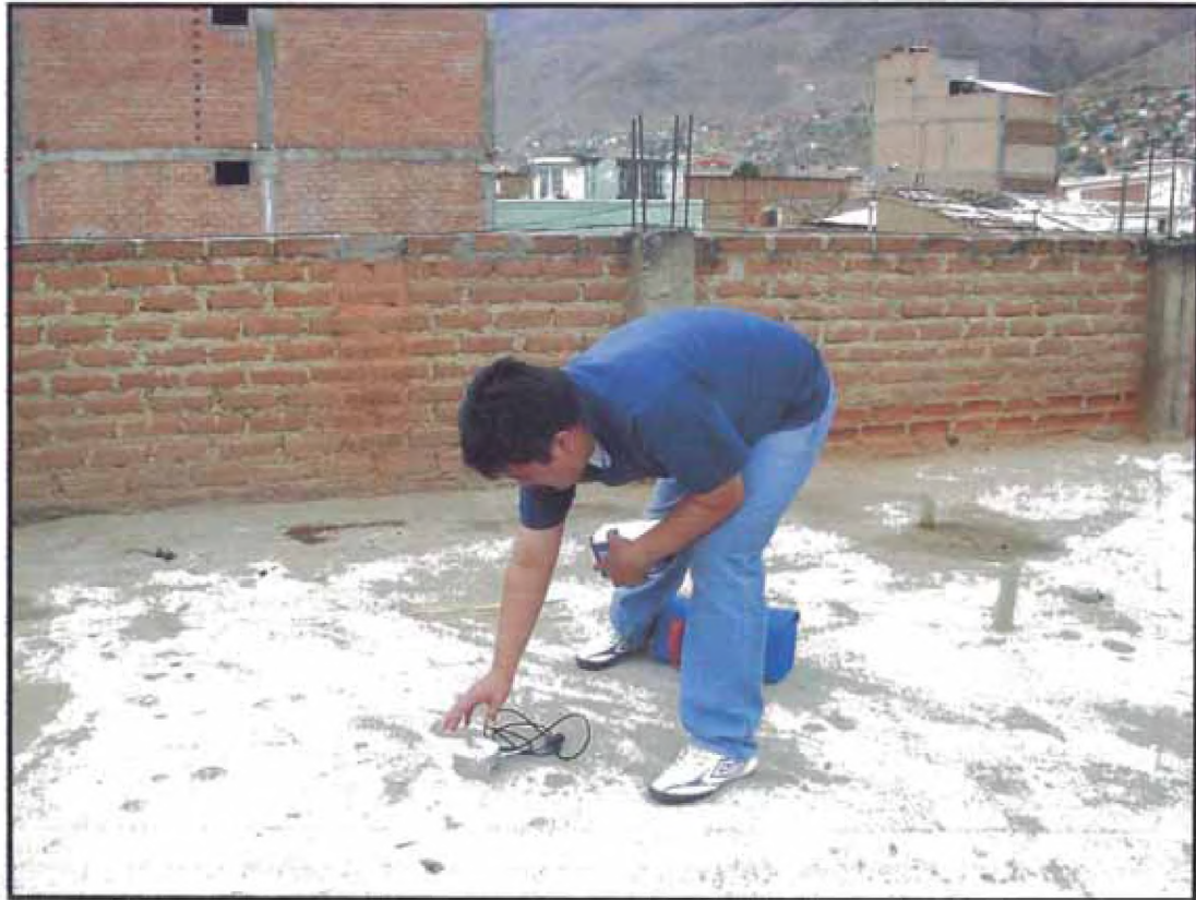
Fotografía 9.- Orientación y ubicación del sensor sobre la loza aligerada.
