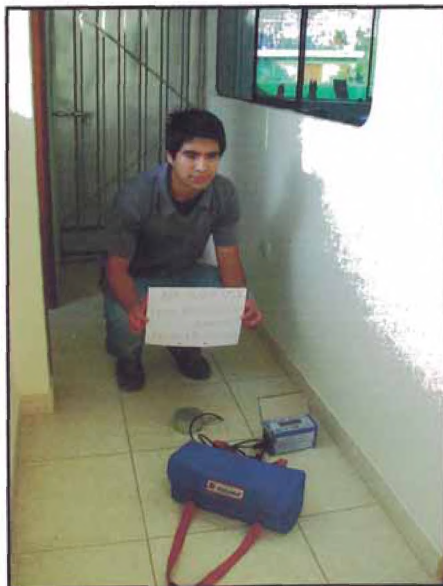
Fotografía 16.- Medición del periodo de la edificación ubicada en la Av. Malecón A. Robles N° 680.
