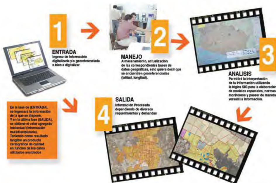
Figura 4.3.- Esquema grafico de la lógica de las funciones de los SIG.
