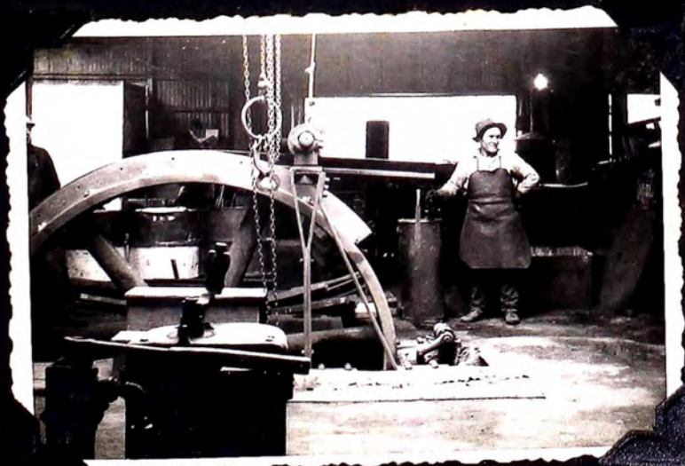
Foto 22.- "Rola" grande. Terminando el moldeado, véase la parte recta del riel y las cadenas listas para sacarlo.
