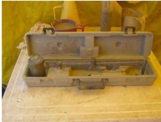
Figura 6-1: Control de fluidez y densidad de la mezcla
