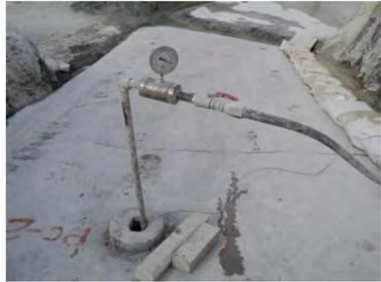
Figura 6-3: Verificación de la presión en el manómetro de la boca del taladro.
