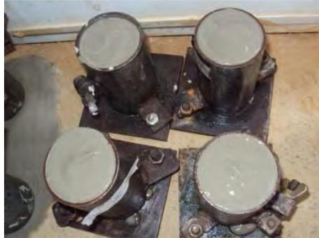
Figura 3-7: Briquetas con lechada de cemento
