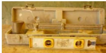
Figura 3-2: Balanza de lodos
