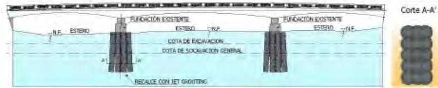
Figura 5-18: Calzaduras como refuerzo de estructuras antiguas
