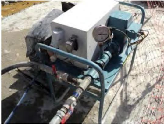
Figura 6-2: verificación de la presión en el manómetro del registro
