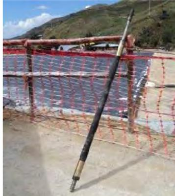
Fig. 4-3: Packer hidráulico
