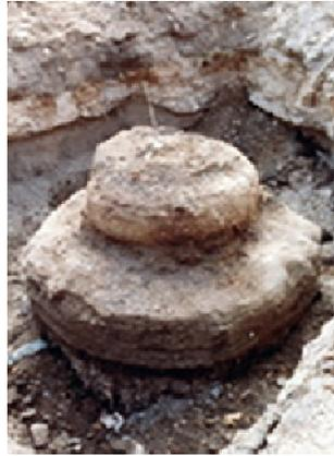
Figura 5-15: Estrangulamiento por cambio de suelo.
