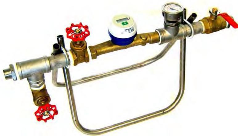
Figura 2-8: Equipos para ensayo de Lugeon, (manómetro y caudalímetro)
