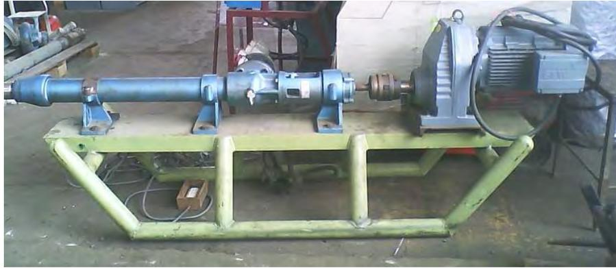
Fig. 4-1: Bomba inyectora de grout
