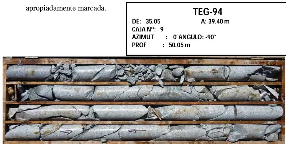
Figura 2-1: Logeo Geológico, las cajas deben almacenarse cuidadosamente con los cores, para mostrar en el futuro las evidencias geológicas y geotécnicas
