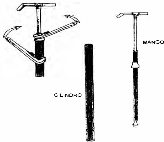
Figura N° 7: Desarme del cilindro, válvula de pie.
