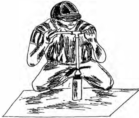
Figura N° 8: Purga del manubrio por endurecimiento.
