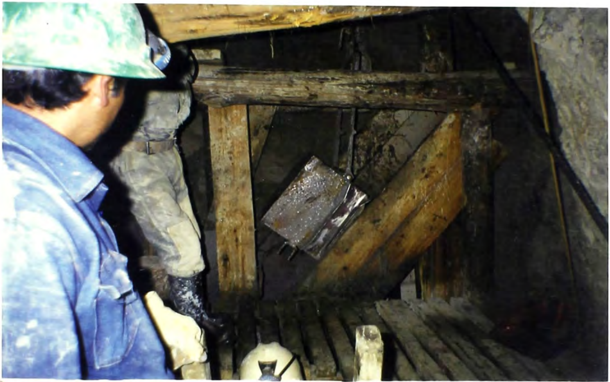
Vista del Sistema de Descarga y del Balde o Skip en el Pique 181 E V-8 Nv. 5100 Mina Pillune
