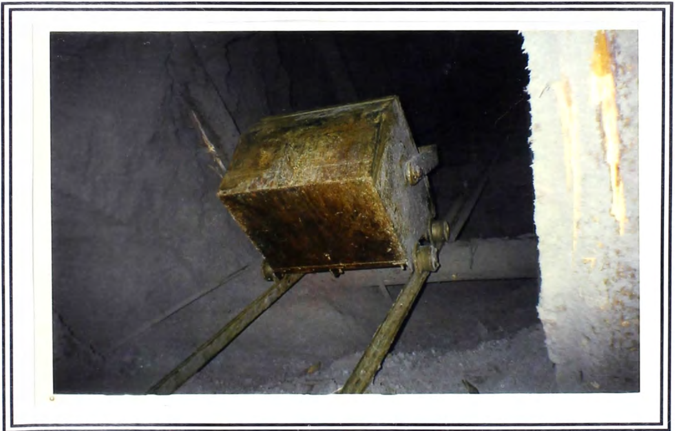
Vista del Entibado e Izamiento del Skip diseñado en el Inclinado 690 E V-1 Nv. 5150 Mina Apacheta
