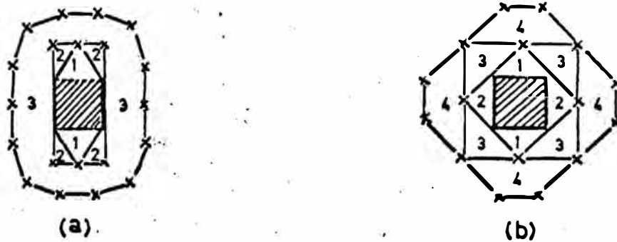
Figura 3.9.- Distancia entre los taladros cargado y vacío para diferentes tipos de rocas. Las letras corresponde a los tipos de roca de la tabla 3.4
