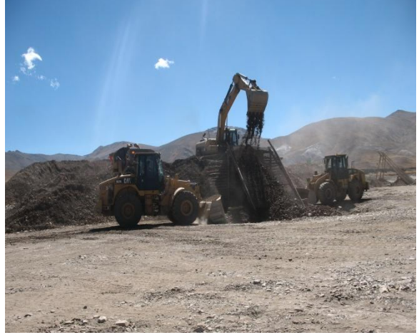
Se Realiza la Explotación y Producción del Material de la Cantera del Km 56+700. Se hace controles según Normas
