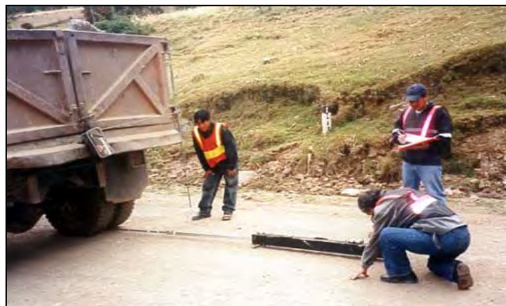
Figura 3.14. Medición de deflexiones Fuente: MTC Dirección de Estudios Especiales
