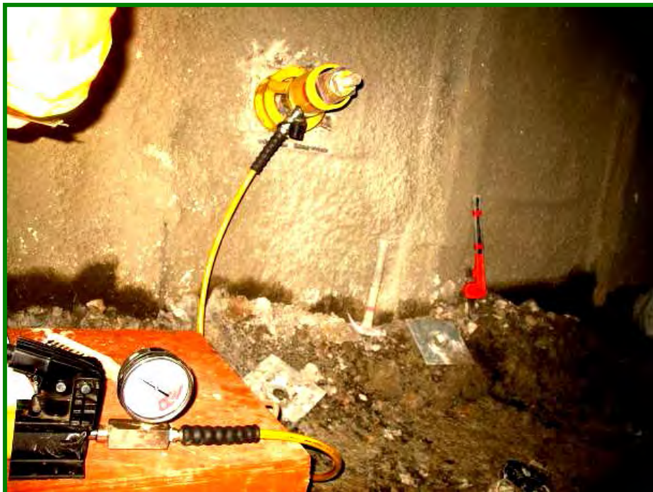
Fotografía 7: Equipo para prueba de tracción de pernos.
