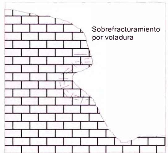
D. Roca Homogénea diaclasada. Bloques sueltos por voladuras.
