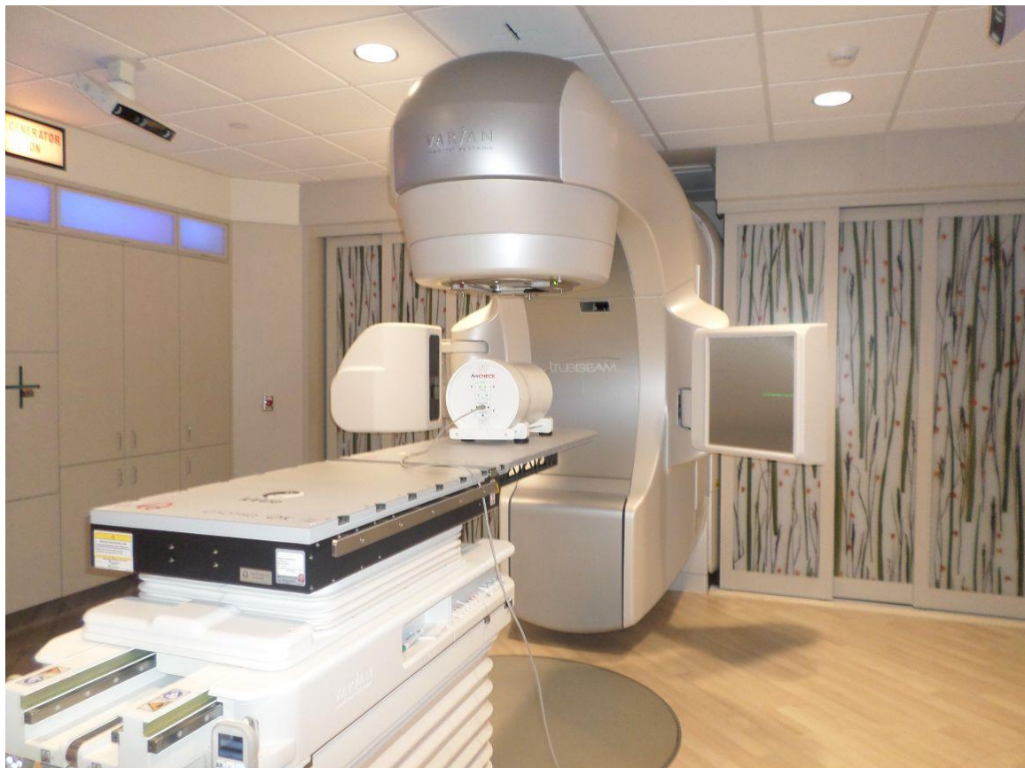
Figura 2.21. CC usando el ArcCHECK® de Sun Nuclear y el acelerador lineal TrueBeam STX de VARIAN en el UC Irvine, California [Foto tomada por el autor].
