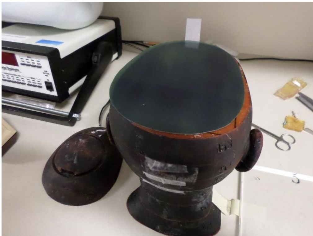
Figura 2.15. Película dosimétrica Gafchromic EBT3 ovalada irradiada en el fantoma antropomórfico de cabeza. Se cortó las películas con la forma de la superficie del fantoma ) [Foto tomada por el autor].
