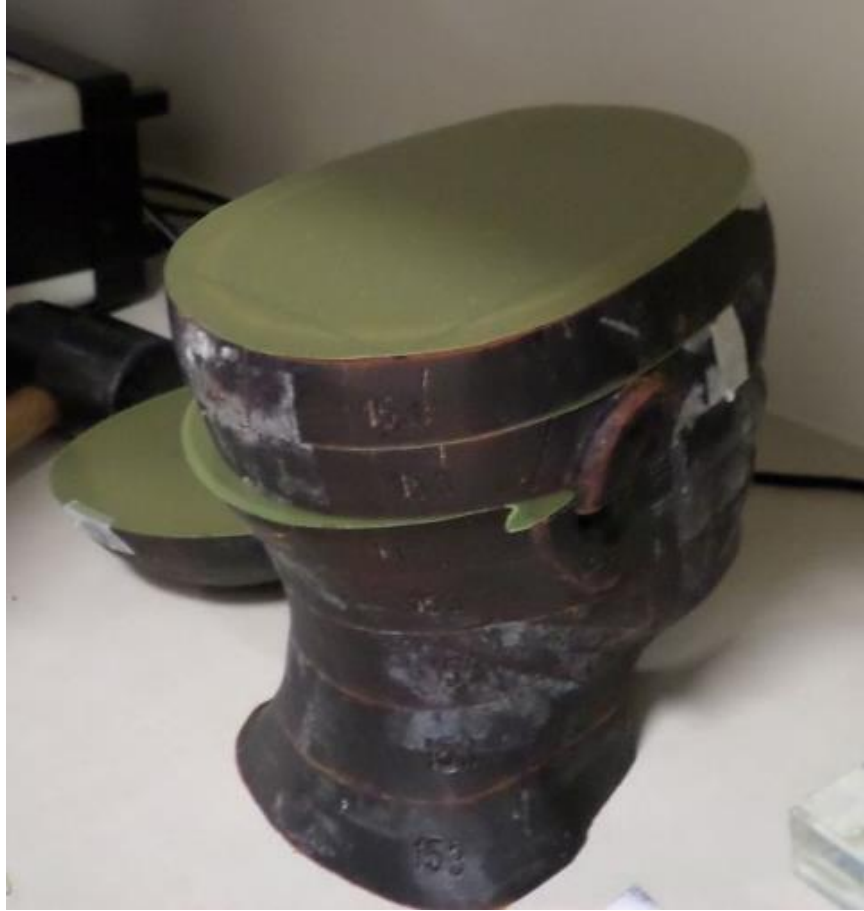
Figura 2.9. Colocación de las películas dosimétrica Gafchromic EBT3 en cada capa del fantoma antropomórfico de cabeza para la irradiación. Se colocaron cuatro películas en el interior del fantoma [Foto tomada por el autor].
