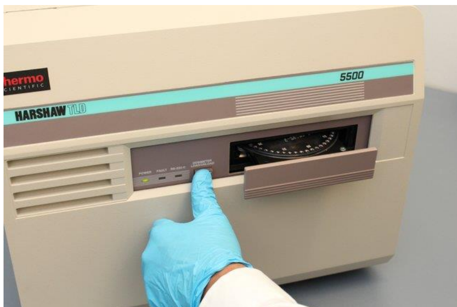
Figura 2.18. Lector de dosímetros TLD.
