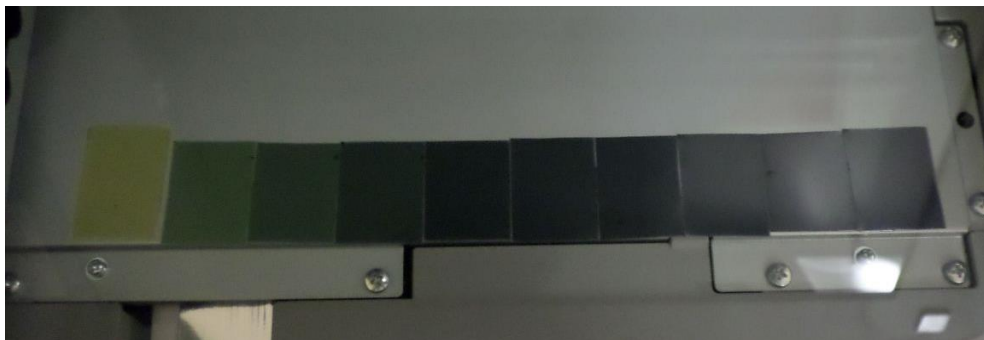
Figura 2.7. Calibración de películas dosimétricas radiocrómicas Gafchromic EBT3. Se observa diferente contraste de las películas, mientras mayor sea la dosis absorbida suministrada, mayor será el oscurecimiento de la película [Foto tomada por el autor].
