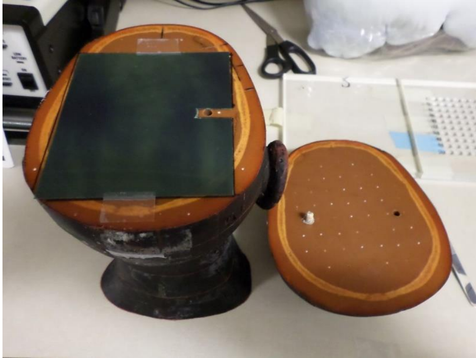
Figura 2.14. Película dosimétrica Gafchromic EBT3 rectangular irradiada en el fantoma antropomórfico de cabeza. En un primer momento se cortó las películas de forma rectangular [Foto tomada por el autor].
