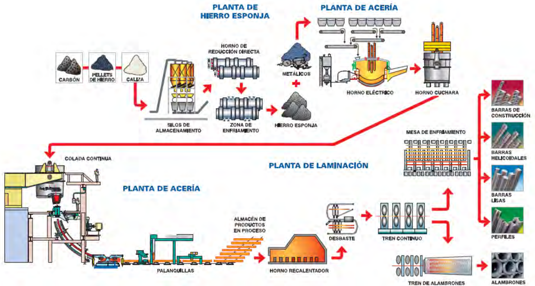
Figura 4.1 Esquema de Producción de Acero de la Planta de Pisco {32}
