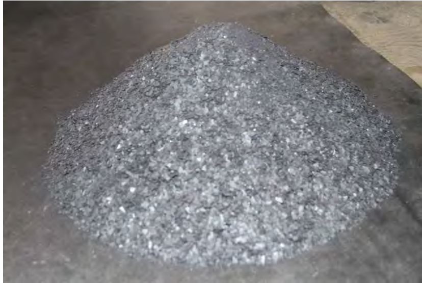
Foto 1.1: Cascarilla de laminación.
