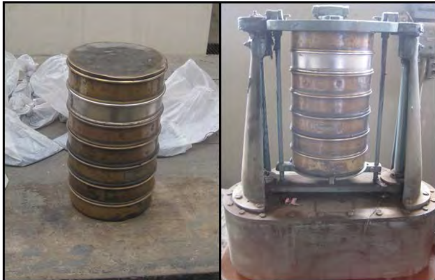
Foto 1.2: Serie de mallas ASTM y Ro – Tap.
