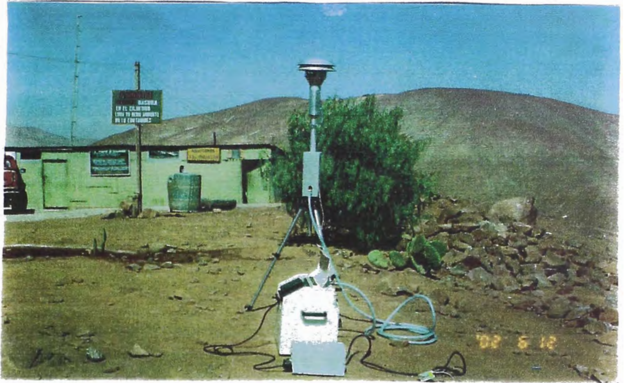
Foto 30.- PM10, medidor de partículas menores a 10 micrones.
