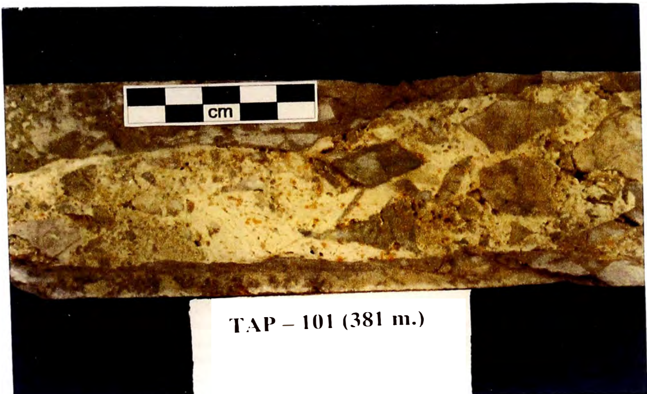
Foto N° 17 : Muestra de un testigo diamantino perforado verticalmente, en el cual se observa una brecha que corta una roca caja silicificada, esta brecha tiene una matriz fuertemente silicificada. El sondaje diamantino pertenece al depósito El Tapado.
