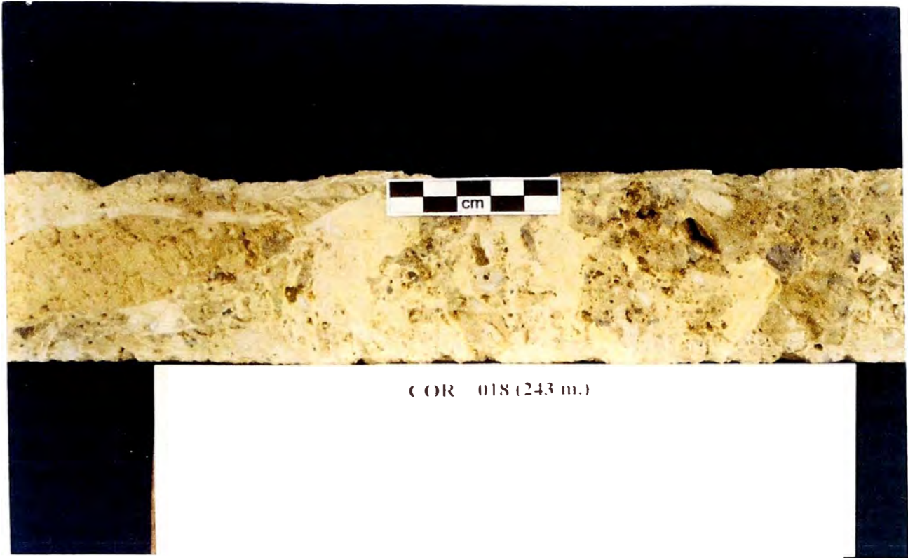
Foto N° 18 : Muestra de un testigo diamantino, en la cual se observa varias brechas silicificadas, algunas con textural fluidal como la sílice de color crema.
