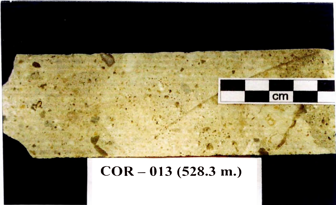
Foto N° 04 : Muestra de un testigo diamantino, en la cual se observa la unidad UFgs, con predominio de fragmentos gruesos heterolíticos (hasta 5cm), la matriz está compuesto por cristales y fragmentos finos (<0.5 cm). Es la unidad mas profunda identificada.
