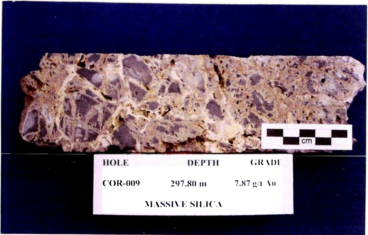
Foto N° 41 : Muestra macroscópica, de una roca silicificada que se encuentra fracturada, y dichas fracturas están rellenas por Baritina (color blanco).
