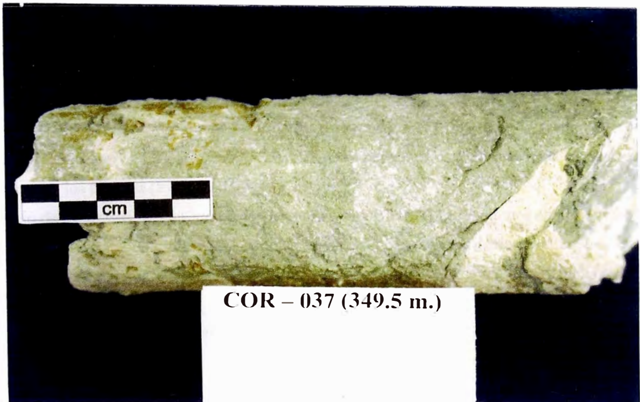
Foto N° 36 : Muestra de un testigo diamantino, en el cual se observa la alteración de arcilla (caolín) con pirita, desarrollado en la unidad UTFxb (tufo de cristales).
