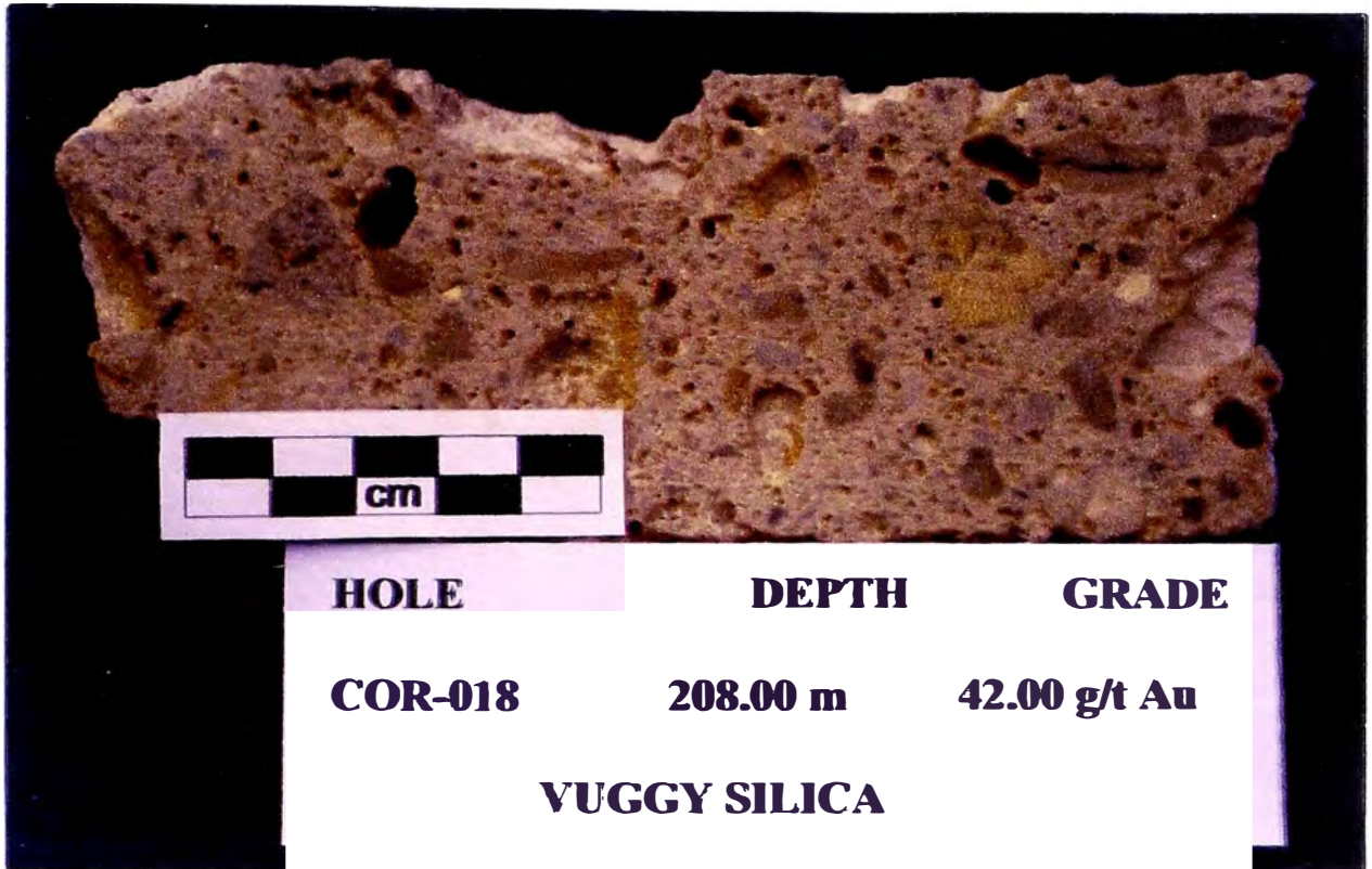
Foto N° 55 : Muestra macroscópica de una roca fragmental gruesa (brecha heterolítica) con fragmentos silicificados y con matriz de fragmentos finos. Se observa muchas vesículas de lixiviación
