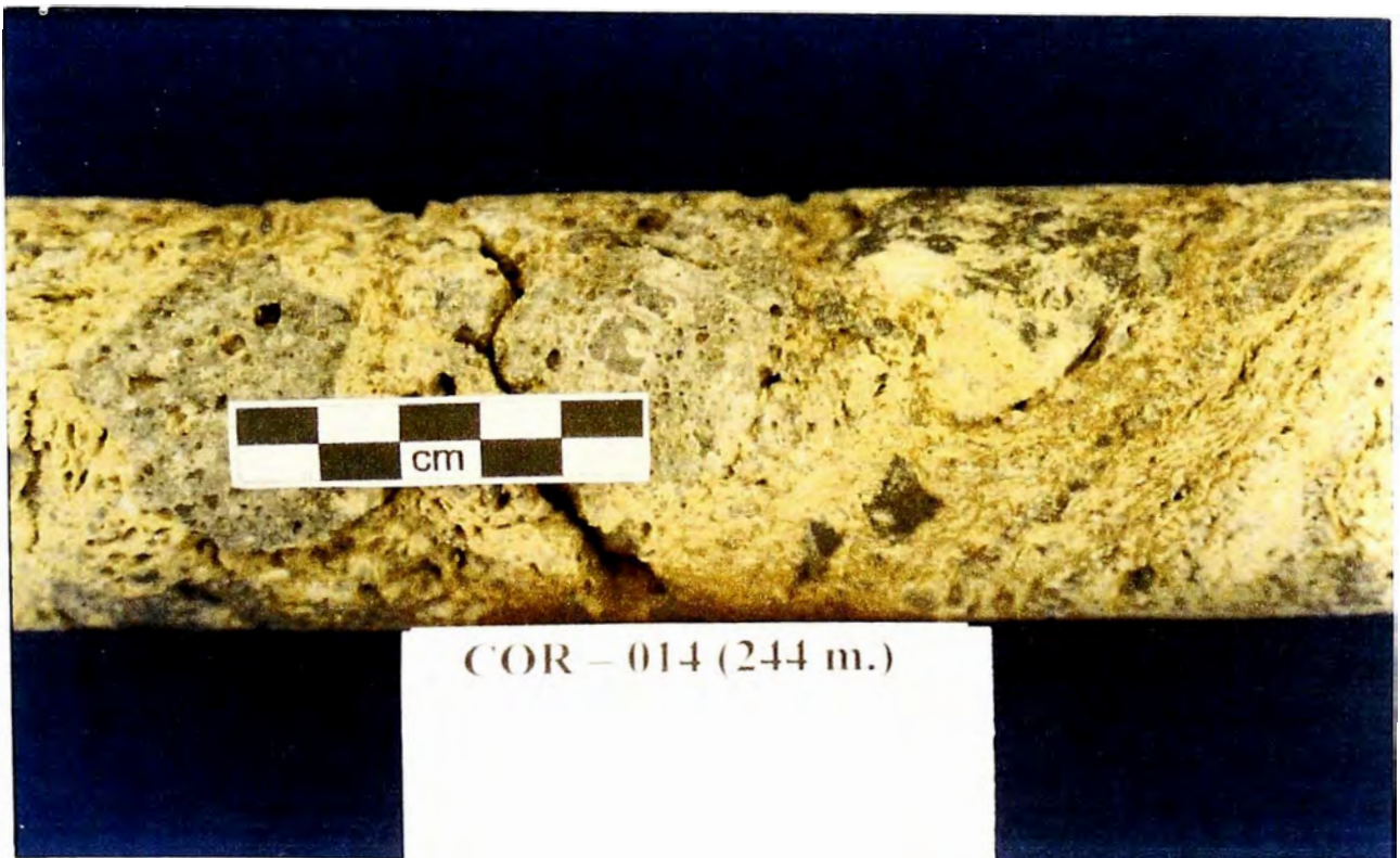
Foto N° 21 : Muestra de un testigo diamantino, en la cual se observa con mayor claridad la textura fluidal de la sílice de color crema que corta una brecha pre-existente y está englobando los fragmentos de esta brecha previamente silicificada.
