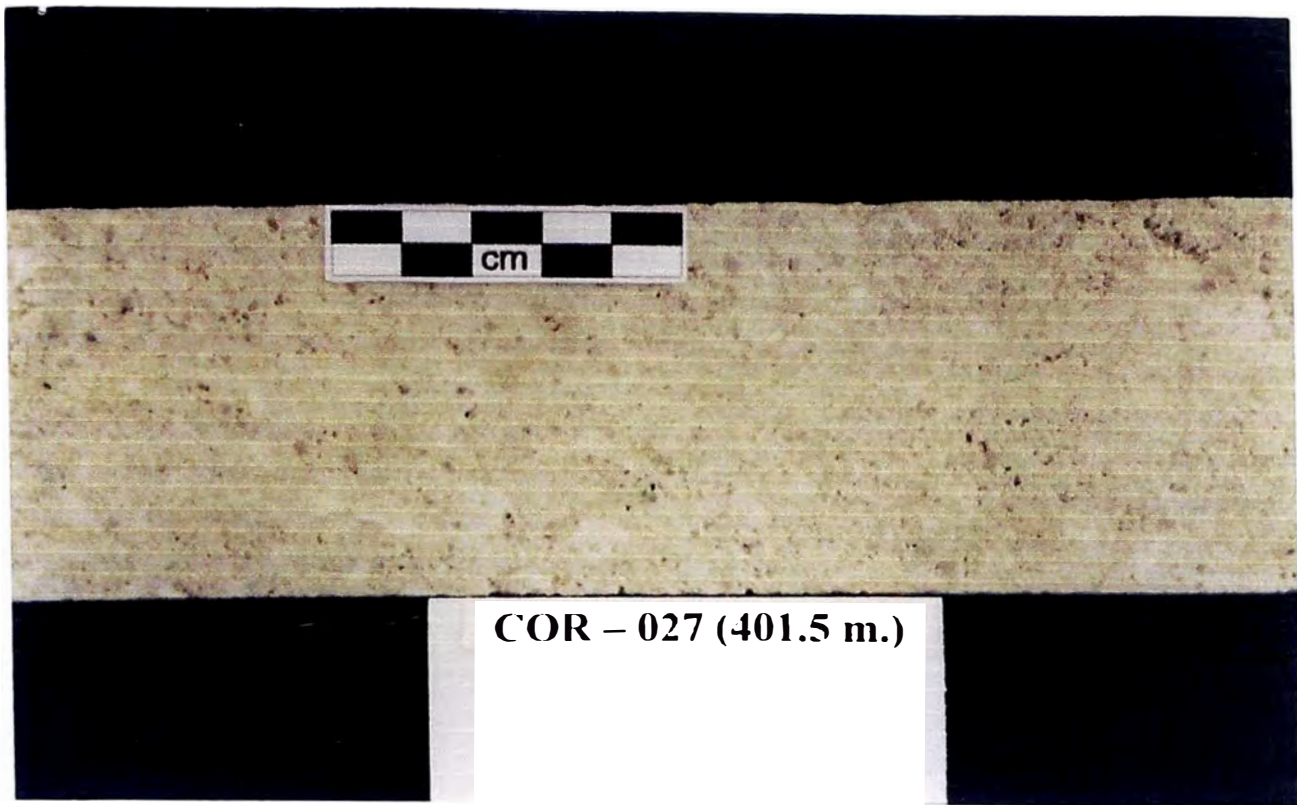
Foto N° 06 : Muestra de un testigo diamantino, en el cual se observa la unidad UFxfs, matriz rica en cristales (feldespatos), cavidades dejados por los cristales pre-existentes que fueron lixiviados, y muchos fragmentos finos silicificados.
