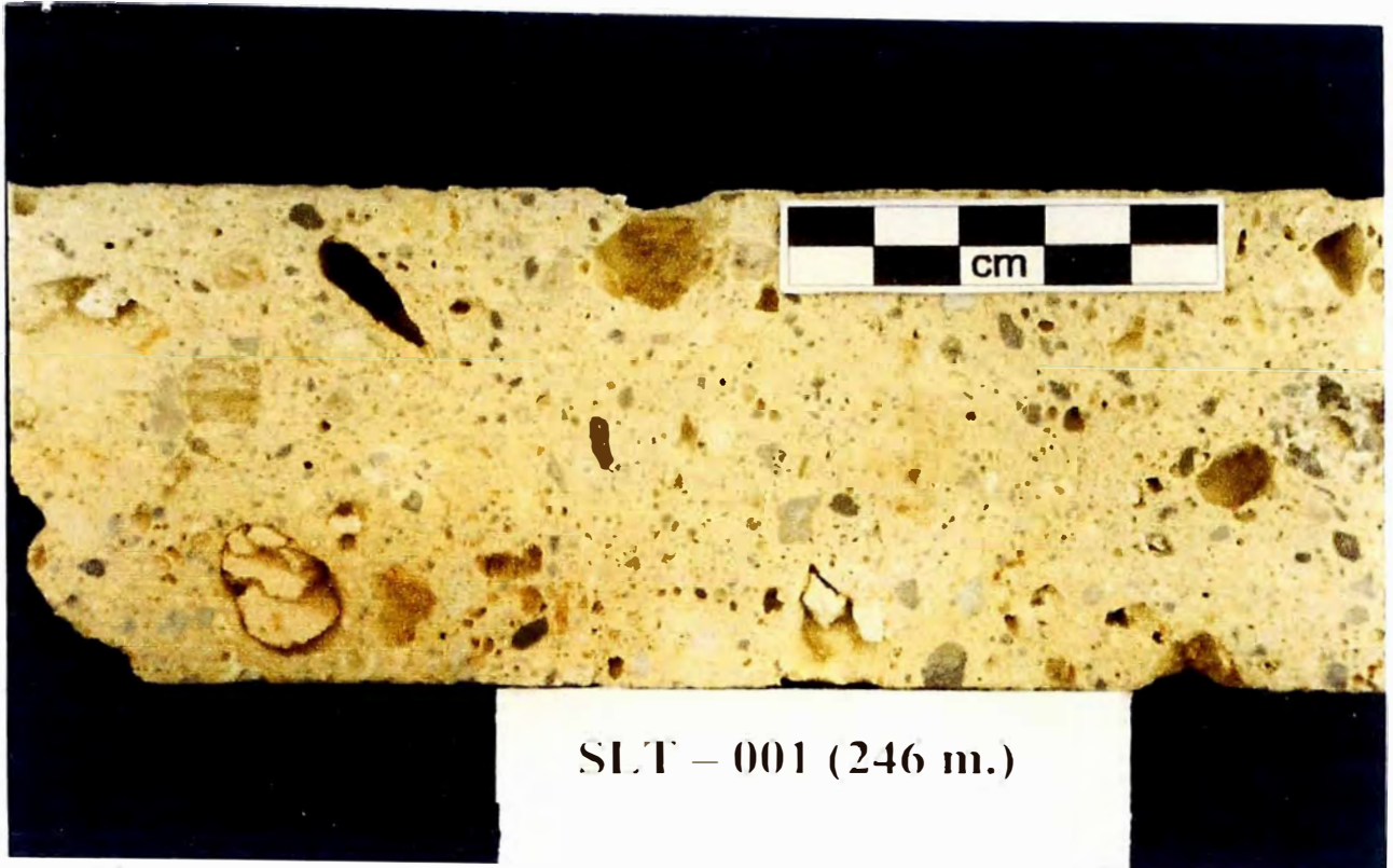
Foto N° 14 : Muestra de un testigo diamantino, en la cual se observa una brecha heterolítica matriz soportada. La presencia de grandes cavidades es debido a la lixiviación de fragmentos alterados a argílico avanzado o argílico.
