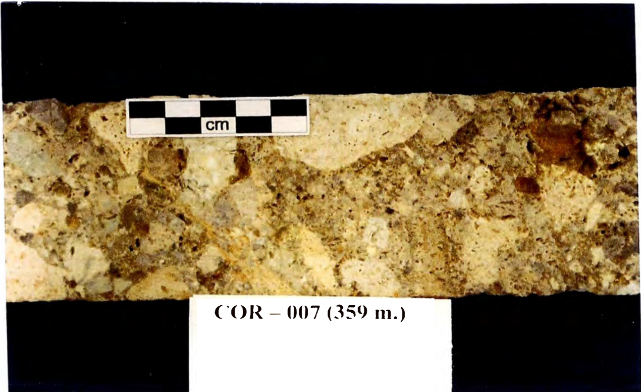
Foto N° 16 : Muestra de un testigo diamantino, en el cual se observa una brecha heterolítica con los fragmentos previamente silicificados. También se observan venillas silíceas de color crema con textura fluidal.
