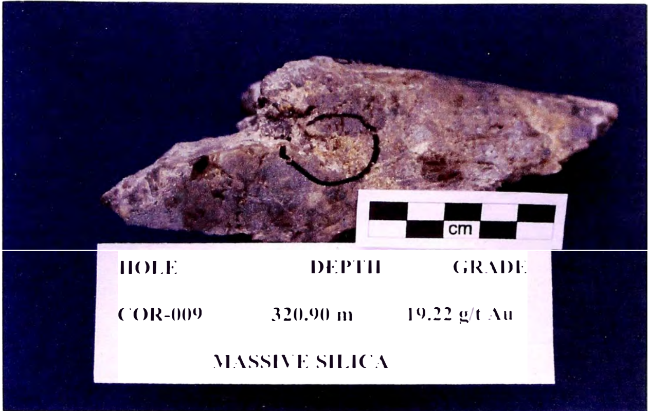
Foto N° 45 : Muestra macroscópica de un tufo fuertemente silicificado con baritina y oro visible relleno de fracturas.
