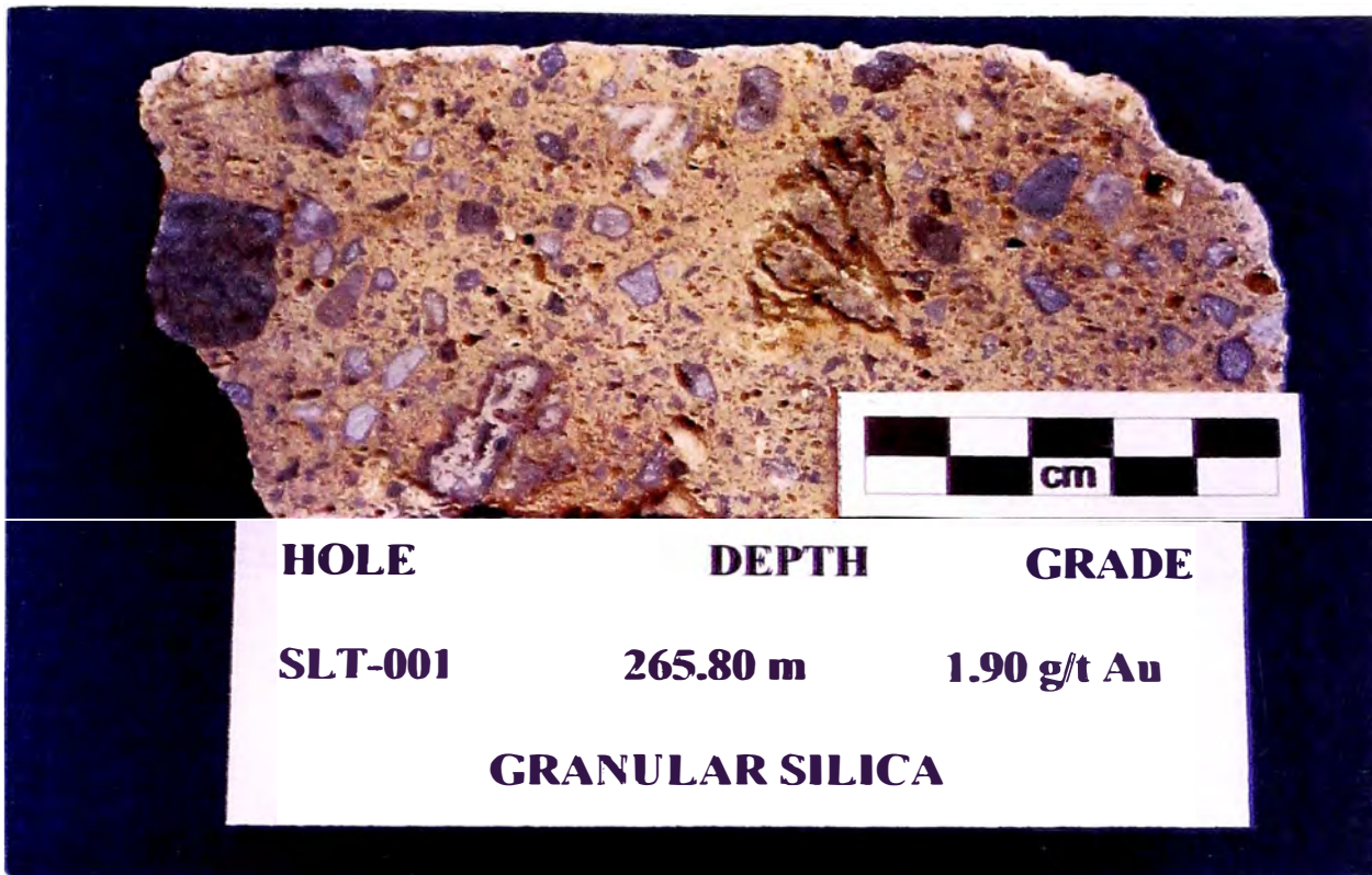
Foto N° 37 : Muestra macroscópica de una brecha con fragmentos heterolíticos silicificados en una matriz de fragmentos finos.
