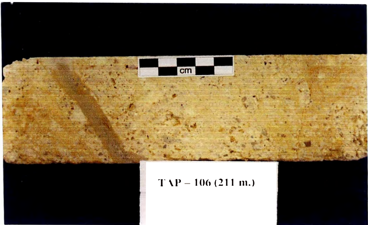
N° 13 : Muestra de un testigo diamantino, en la cual se observa una brecha similar al de la foto anterior, proviene del depósito El Tapado. Se observa de fragmentos finos como polvo de roca con una textura fluidal. Es interpretada como una brecha freática.
