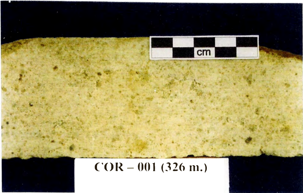
Foto N° 29 : Muestra de un testigo diamantino, en la cual se observa una roca de la unidad Uxf con alteración de sílice granular.
