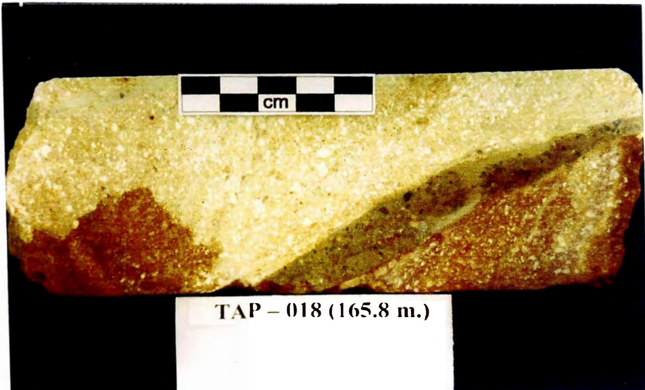
Foto N° 11 : Muestra de un testigo diamantino, en el cual se observa la misma unidad UTFxb alterada a sílice alunita. Esta unidad está cortada por una delgada brecha heterolítica silicificada.
