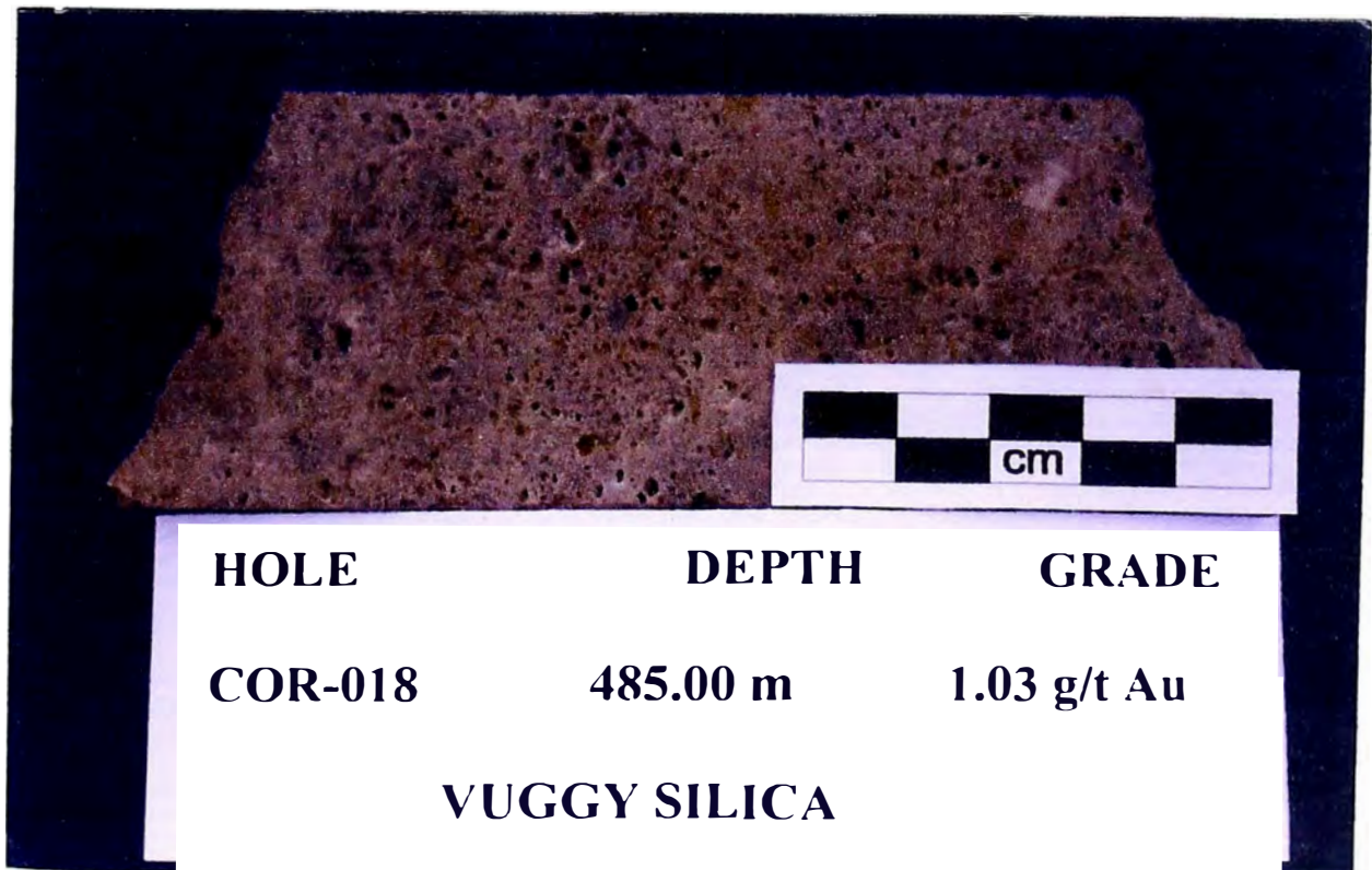
Foto N° 30 : Muestra de un testigo diamantino, en la cual se observa una roca rica en cristales con alteración de sílice vuggy, debido a la lixiviación de los feldespatos de la roca original.
