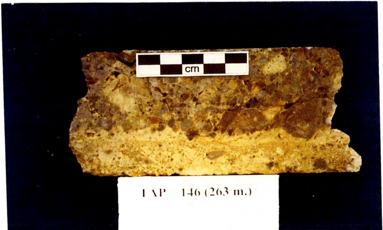
Foto N° 19 : Muestra de un testigo diamantino, perforado verticalmente, en el cual se tiene otro ejemplo de la geometría vertical de una brecha con sílice de color crema y textura fluidal. La brecha con sílice de color crema está cortando a otra brecha heterolítica de color gris.
