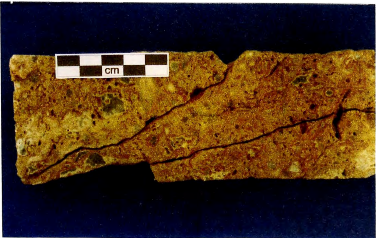
Foto N° 32 : Muestra de un testigo diamantino, en la cual se observa la alteración sílice masiva con óxidos de hierro, remanentes de pirita (playas) y débil presencia de textura vuggy.
