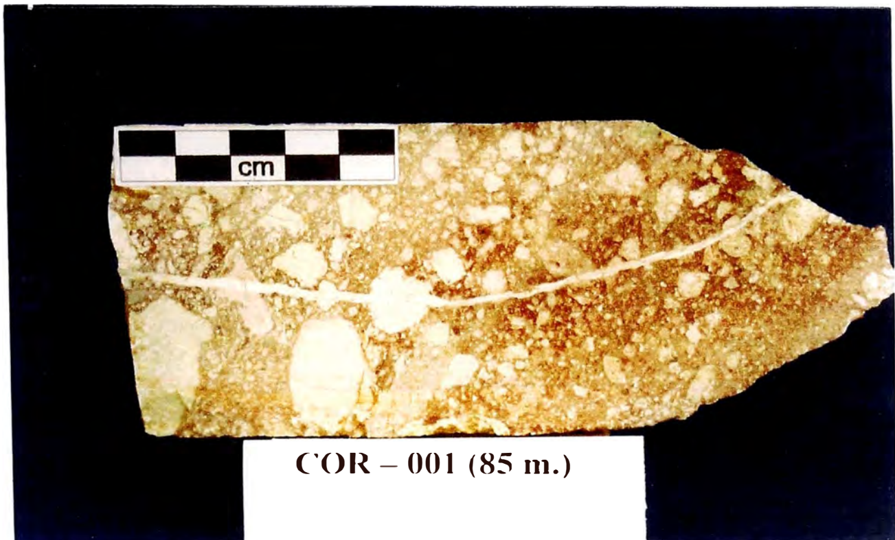
Foto N° 09 : Muestra de un testigo diamantino, de la unidad UF xg alterado a sílice alunita. Se observa que predominan los fragmentos de la misma composición.
