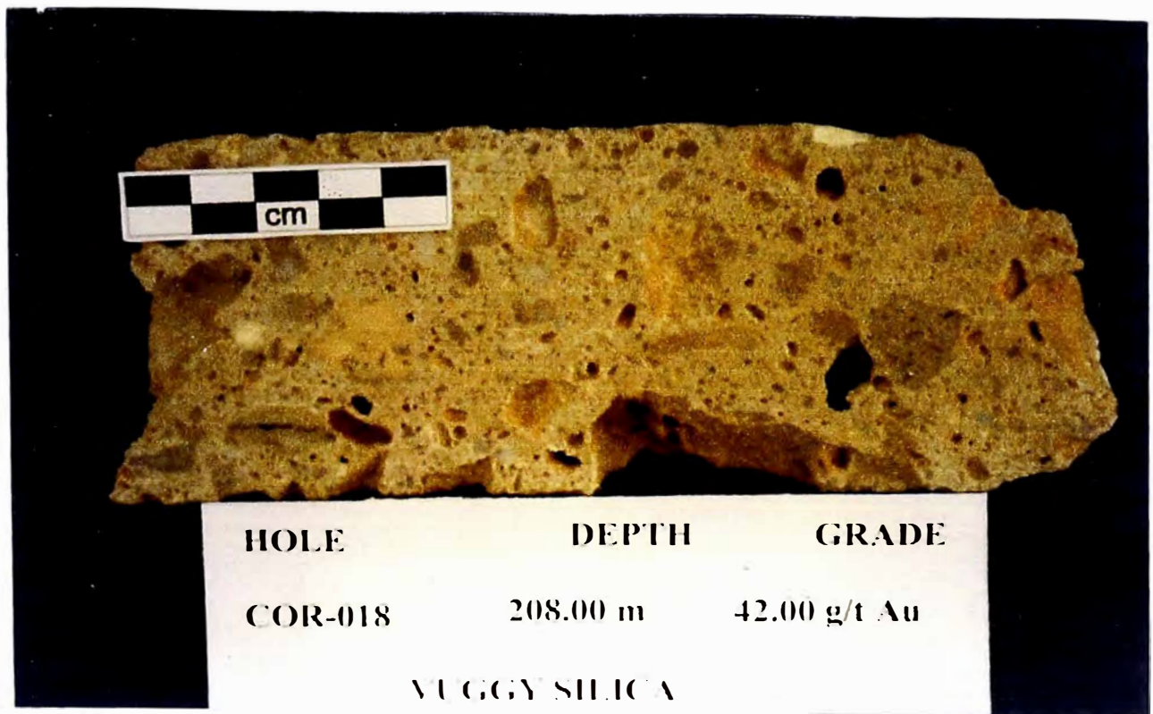
Foto N° 15 : Muestra de un testigo diamantino, similar a la muestra anterior con muchas cavidades de fragmentos que fueron lixiviados. En esta muestra se puede observar cristales muy finos de baritina desarrollados en las cavidades (zona de alta ley).
