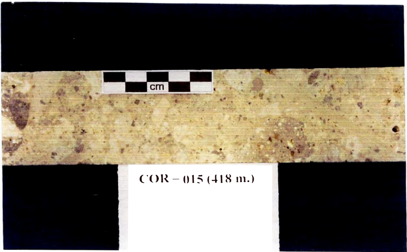
Foto N° 12 : Muestra de un testigo diamantino, en la cual se observa una brecha heterolítica con fragmentos silicificados, en una matriz de fragmentos muy finos. Es interpretada como una brecha freática.
