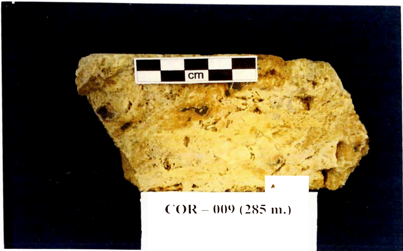
Foto N° 20 : Muestra de un testigo diamantino, en la cual se observa la sílice de color crema (brecha hidrotermal), que a veces forma grandes canales con textura fluidal.
