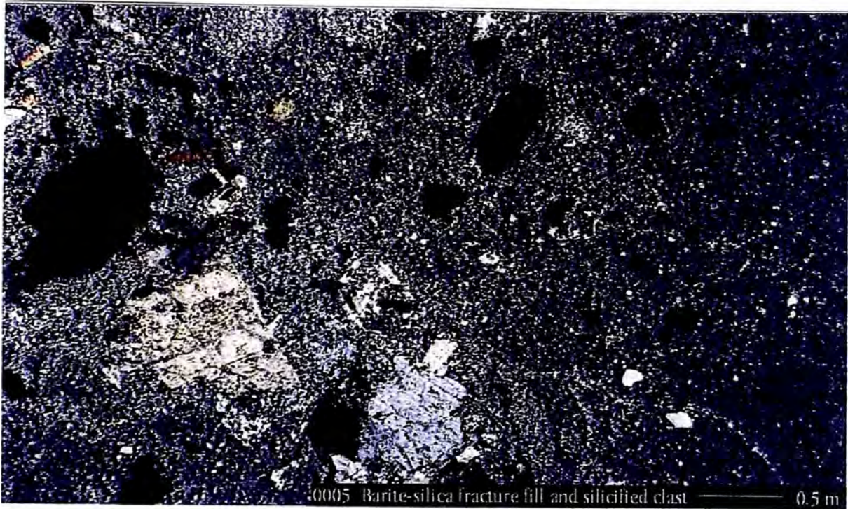
Foto N° 43 : S.D.: Luz polarizada nicoles cruzados, la misma muestra. Se ve baritina y sílice rellenando fracturas (inferior izquierdo) a lo largo de clastos silicificados (superior derecho).
