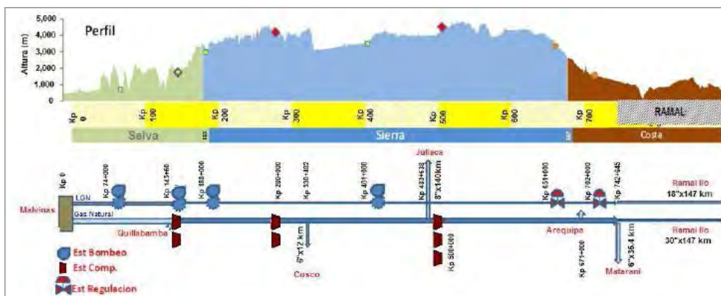
Figura 4.7: esquema simplificado gasoducto sur andino.
