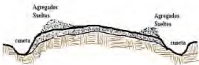
Figura 7: Pérdida de agregados
