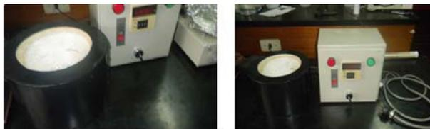
FIGURA 2. Conjunto horno manta térmica y caja controladora de temperatura de la Facultad de Ciencias UNI
