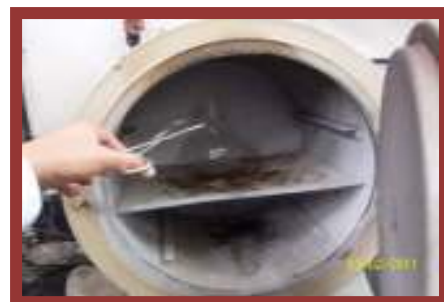
Proceso de acondicionamiento de los balones a 105°C en el horno por 30 min antes de ser pesados.
