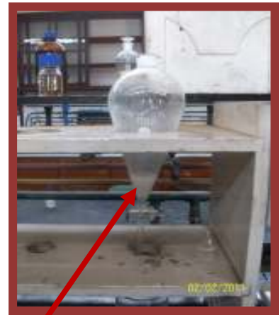
Se presenta una emulsión en la pera del desagüe de pota.
