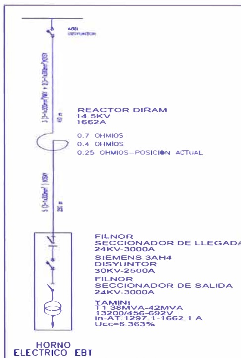
Figura N°2.7 Diagrama unifilar de alimentación del horno eléctrico de SIDEPERÚ
