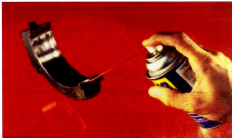
**FIG.4.5. Aceitado de tapa de biela de motor**
