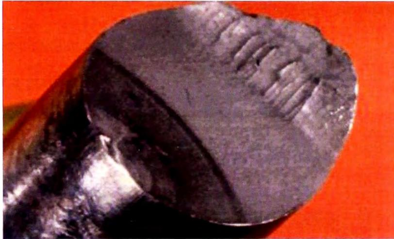
**FIG.4.17. Ampliación de la cara de fractura del perno.**
