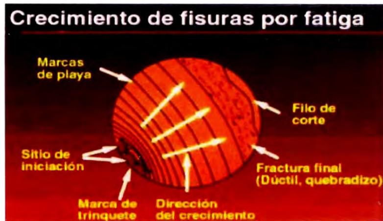
FIG. 4.55. Desarrollo de una superficie de fractura por fatiga.
