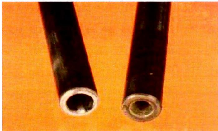
**FIG. 4.11. Comparativo de guías de válvulas de motor.**
