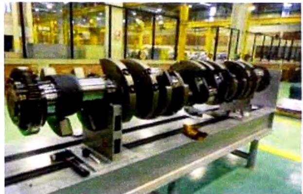
**Fig. 5.29. Cigüeñal ubicado en un banco elevado y giratorio, además de limpio para su inspección respectiva.**
