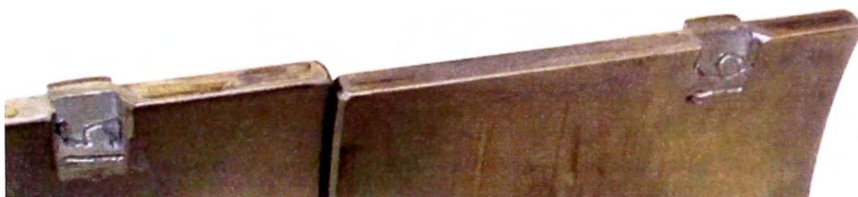
**Fig. 5.14. Luego del desmontaje de los cojinetes se procedió a su identificación (numeración) en la zona correspondiente a su seguro de instalación, dado que en esa zona no se afecta alguna superficie de desgaste que sea de importancia para el análisis de falla.**
