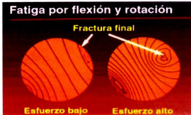
FIG. 4.60. Superficies de fractura por fatiga por flexión y rotación.
