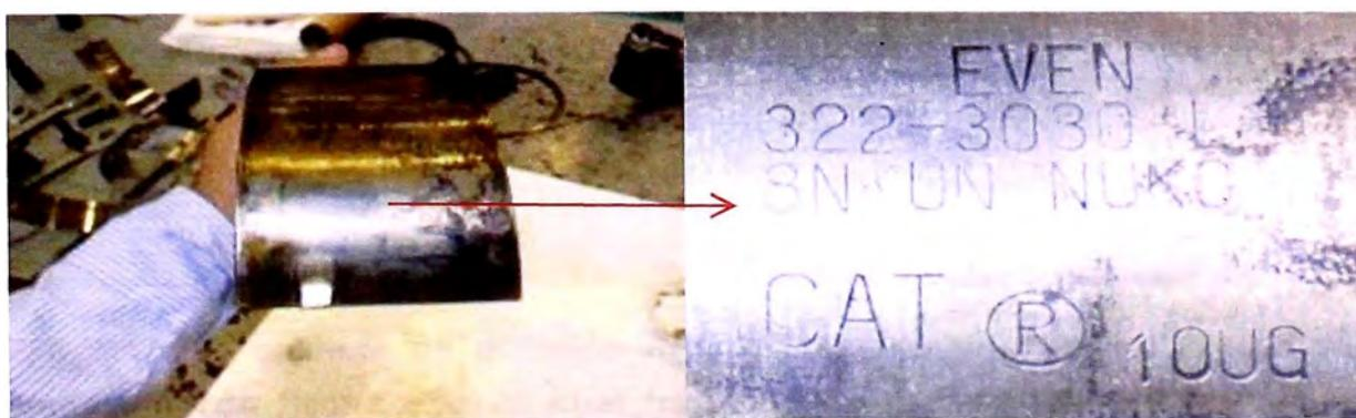
**Fig. 5.15. Se inspeccionó el número de parte NP: 322-3030, códigos de fabricación y marca registrada de todos los cojinetes.**
