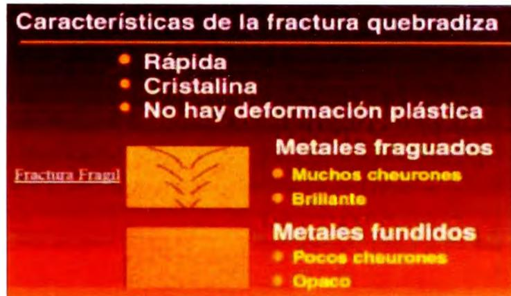
**FIG. 4.41. Características de las fracturas frágiles o quebradizas.**
