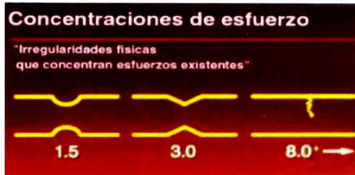
**Fig. 4.39. Concentraciones de esfuerzo en ranuras.**
