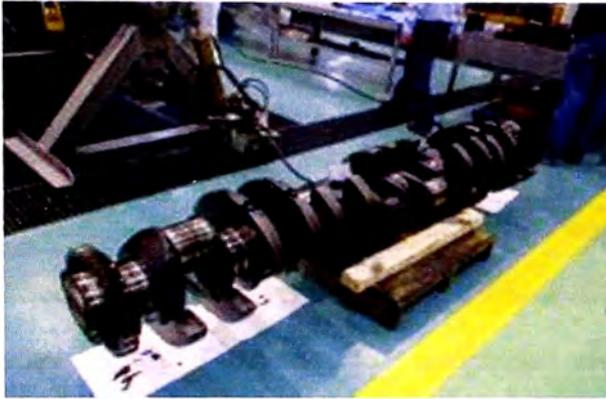
**Fig. 5.28. Cigüeñal recién retirado del monobloque listo para ser ubicado en su bahía correspondiente.**
