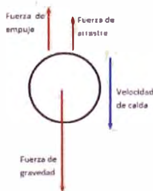
Fig. 2.5 Análisis de fuerzas sobre un grano de sólido en suspensión en el agua.
