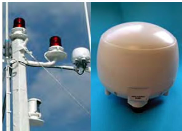
Figura 27. Baliza Argos. Fuente: Argonet
