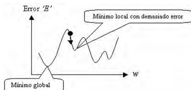
Figura 16. Mínimo global y mínimos locales para la función del error en una red neuronal multi-capas. Fuente: http://www.monografias.com/trabajos901/fundamentos-basicos-reconocimiento-voz/fundamentos-basicos-reconocimiento-voz.shtml
