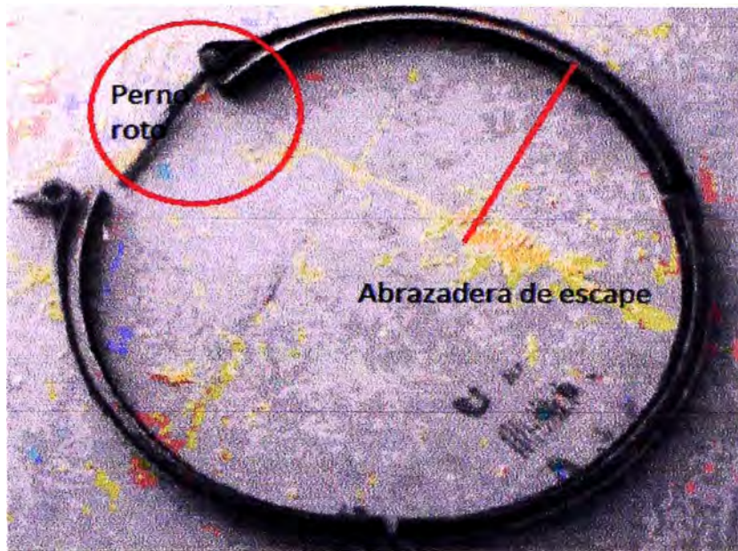
Figura N° 20 - Abrazadera de escape con perno roto.
