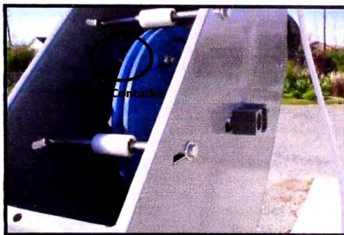
**Foto 3.4: Cabezal del equipo - Posición del Sensor Contador**
