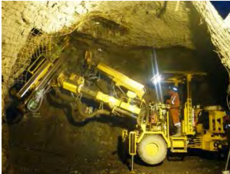
Figura 18: Jumbo Quasar, viene preparando taladros largos en el Tajo 775 del Cuerpo Magaly
