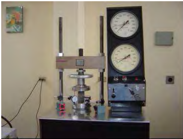
Figura 11. Equipo y muestras para pruebas de resistencia compresiva
