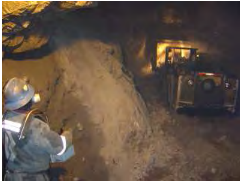
Figura 19: Scoop diesel de 2,2, yd3 a control remoto, en plena limpieza desde un draw point en el tajo 775, Cuerpo Magaly, Nv.4 060, Mina Socorro.
