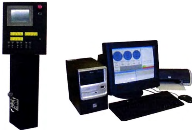
Figura 4.1.4: Powernet Workstation y ordenador de Comando
