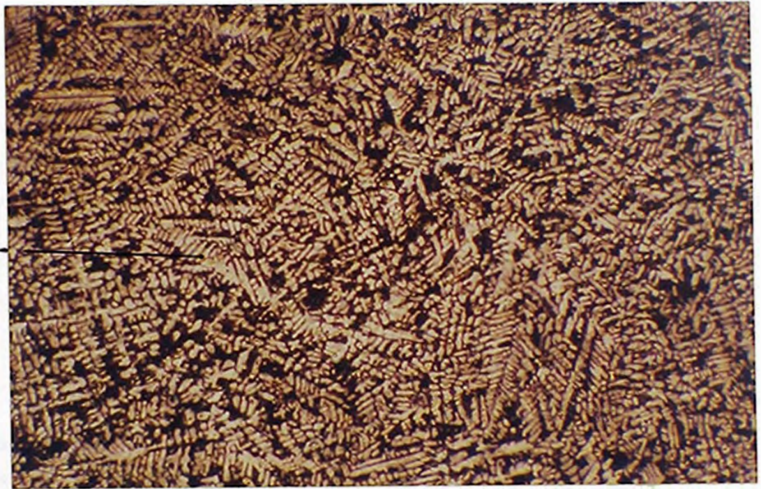
Fotomicrografía 5 . Fundido en molde de grafito, sección longitudinal, zona periférica del lingote, temperatura de colada 520 °C ; (90X).
