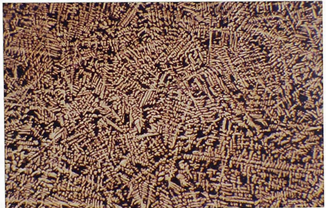
Fotomicrografía 6 . Fundido en molde de grafito, sección longitudinal, zona central del lingote, temperatura de colada 580 °C ; (90X).
