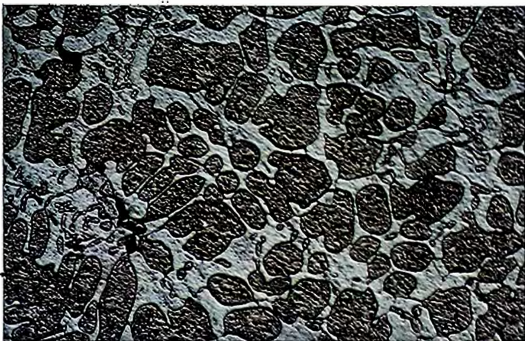
Fotomicrografia 5 . Sección transversal, envejecida a 150 °C por 3 h. ( 150 X ).
