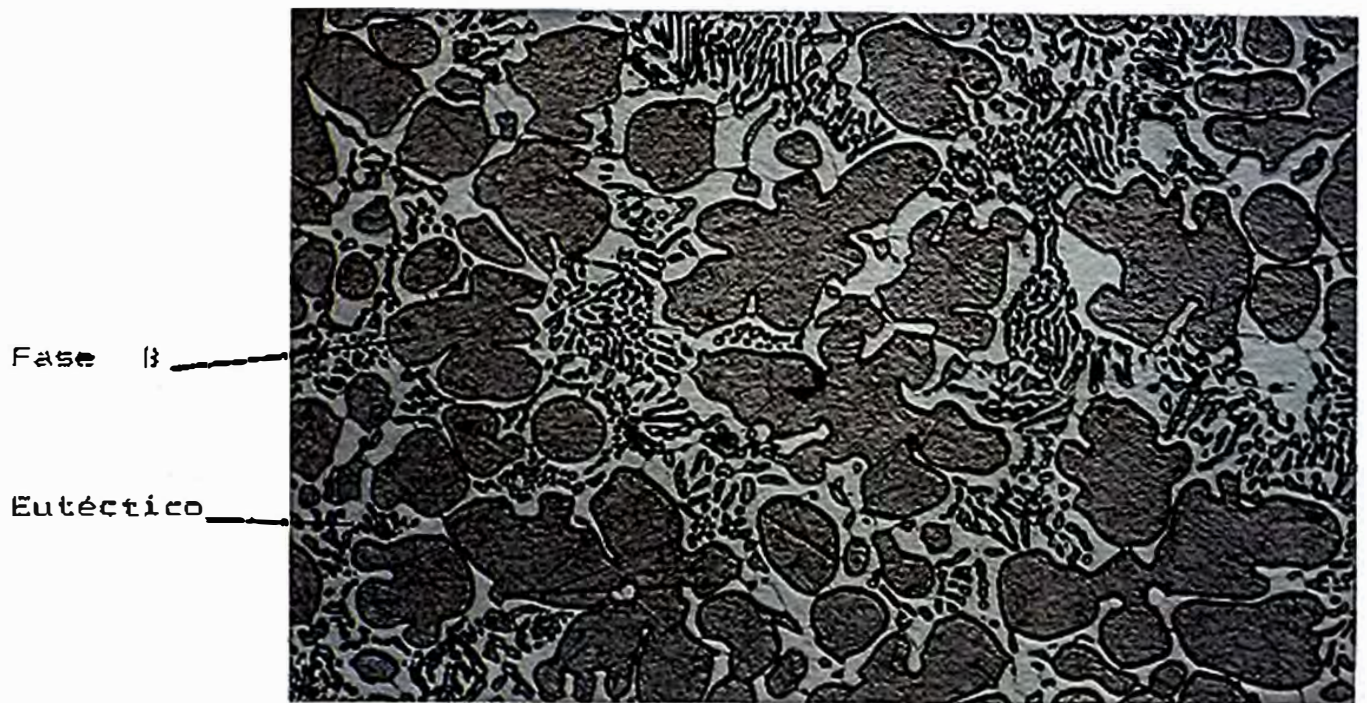
Fotomicrografía 2 . Sección transversal, envejecida a 100
