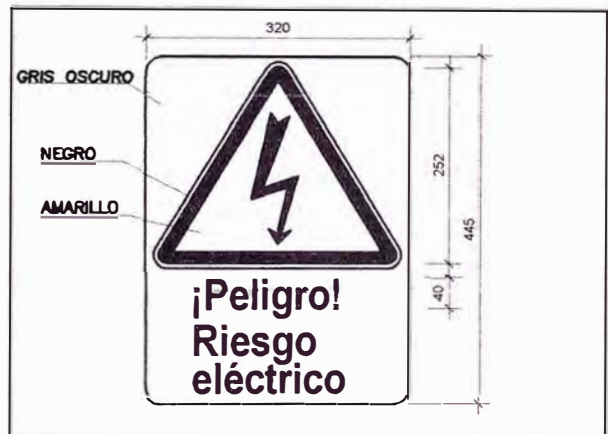
SEÑAL DE RIESGO ELECTRICO ESCALA : 1/10
