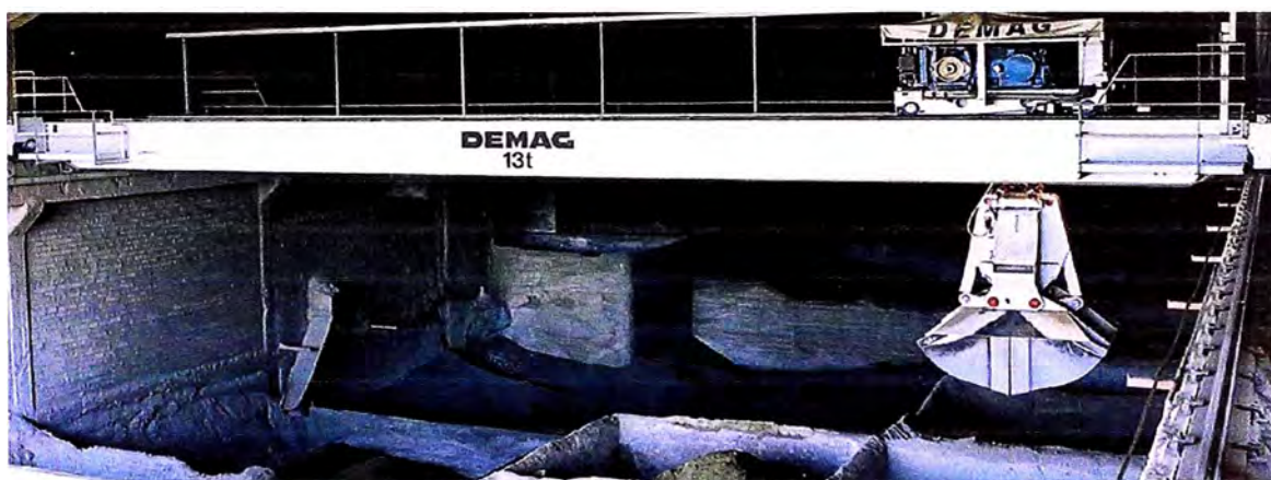
Fig 2.15. Grúa puente para residuos
