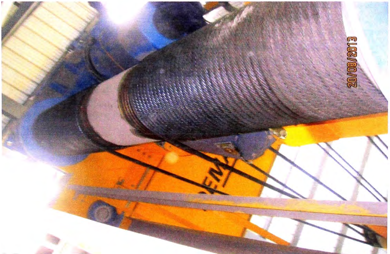
Fig.3.4 Cable de acero enrollado en tambor de doble ranurado
