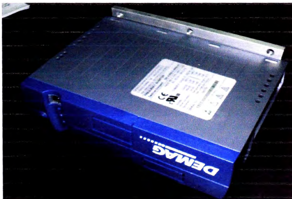
Fig.3.18 Variador de velocidad
