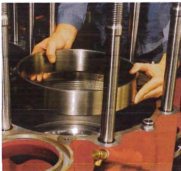
Figura 2.13 Vista del antipolishing ring e instalación de camisa
