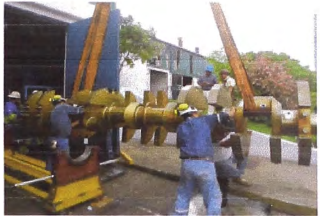
Instalación de hub en cigüeñal
