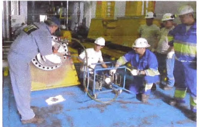
Instalación de hub en cigüeñal
