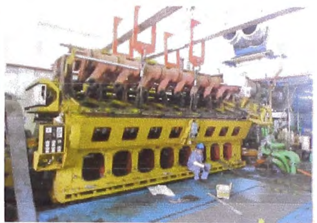
Motor de desacoplado, listo para izaje
