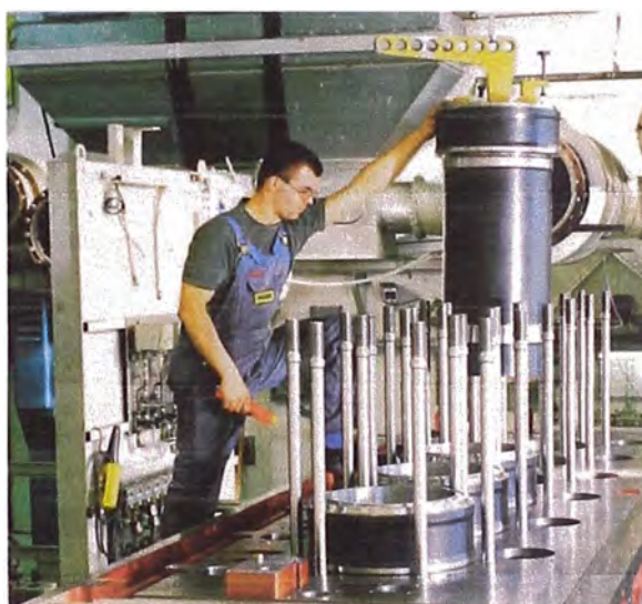
Figura 2.13 Vista del antipolishing ring e instalación de camisa
