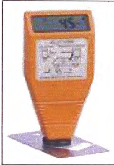
Grafico 23: Medidor de espesor de pintura.
