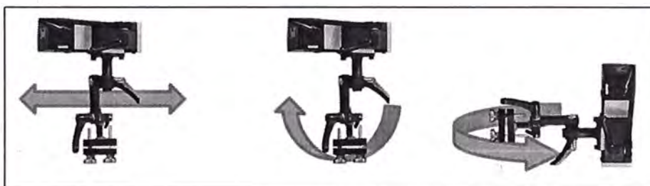
Fig. 5.20 Movimiento Lineal / pendular / Tangencial Fuente : manual carrito KAT Gullco
