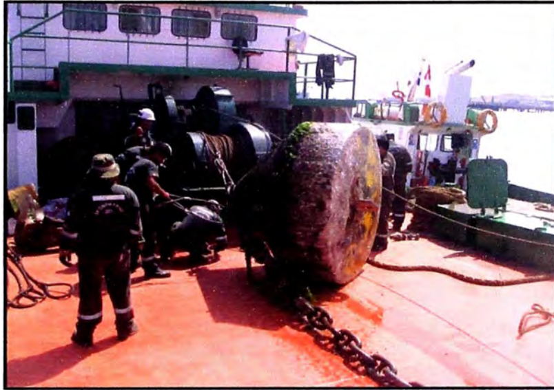
Fig. 2.5: Boya en el centro de cubierta
