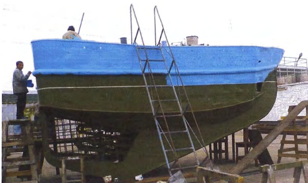
Figura 1. 2: Embarcación auxiliar en Tierra finalizando trabajos de pintura, Fuente: elaboración propia.
