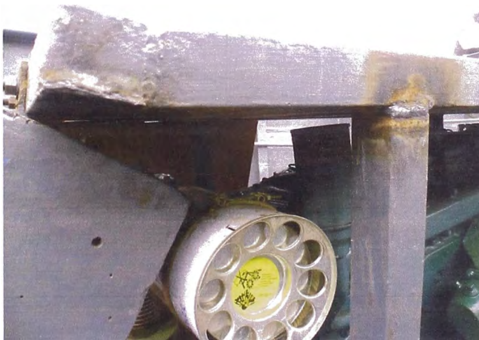
Figura 4. 8 Sirena de Embarcación auxiliar ubicada encima del motor, Fuente: elaboración propia.
