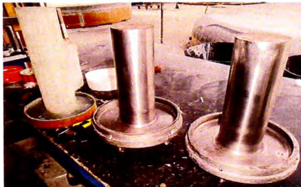
Figura 6.18 MATRICES DE ACERO PARA FABRICACIÓN DE BRIDAS DE FRP
