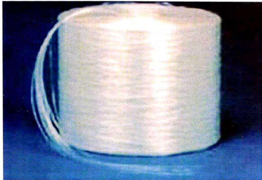
Figura 4.2 ROVING PARA LAMINADO A PISTOLA (SPRAY-UP)
