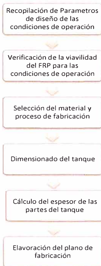
Figura 3.1 DIAGRAMA DE LAS ETAPAS DE DISEÑO DE UN TANQUE DE FRP.
