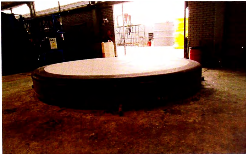
Figura 6.5 TAPA TORIESFÉRICA DE FRP OBTENIDA
