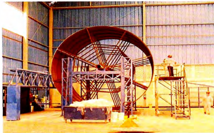
Figura 6.9 ESQUEMA DE LA ESTRUCTURA DE LA MAQUINA PARA TEJIDO POR ENROLLAMIENTO (FILAMENT WINDING)
