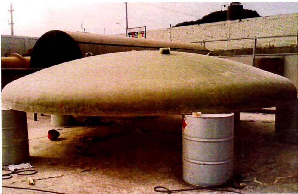
Figura 6.4 TAPA TORIESFÉRICA DE FRP OBTENIDA
