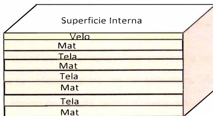
Figura 4.10 CONSTRUCCIÓN TÍPICA DE UN LAMINADO MANUAL
