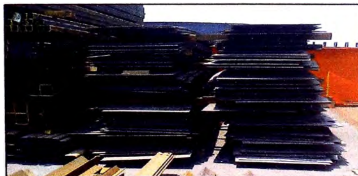
Figura 2.18 Planchas de Casco y Mamparos almacenadas
