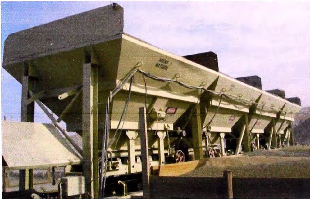
Fig. 3.4 Tolvas de alimentación
