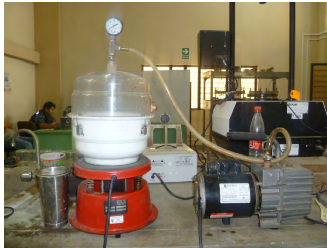
Figura 4.08: Bomba de Vacíos para el Ensayo de Gravedad Específica
