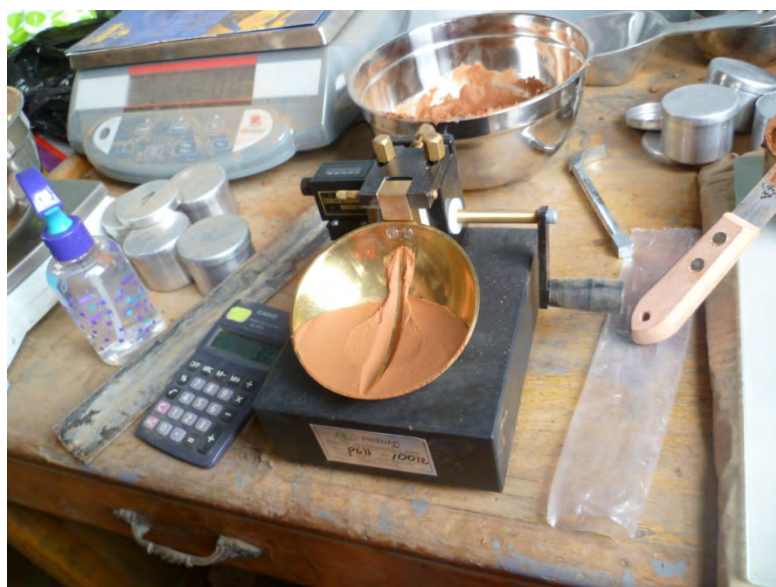
Figura 4.07: Ensayo de Limite Liquido con la Copa de Casagrande
