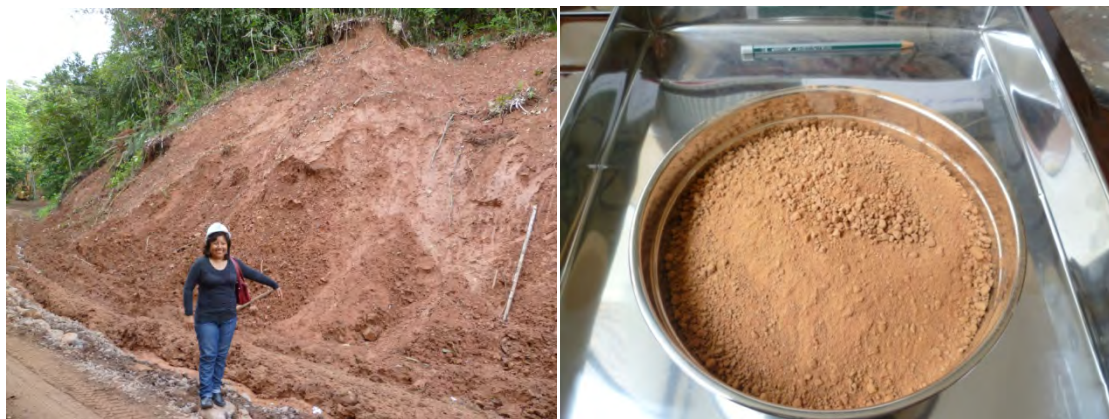
Figura4.02 Vista del Lugar de Obtención de Arcilla en Villarica y Producto Final Pasante la Malla N°4
