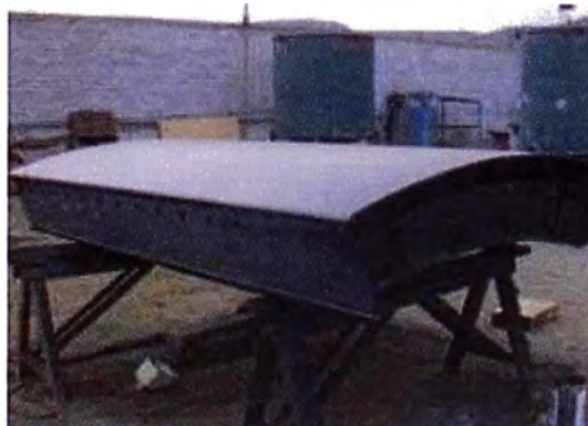
Figura 2.3 Vista lateral posterior de una compuerta radial
