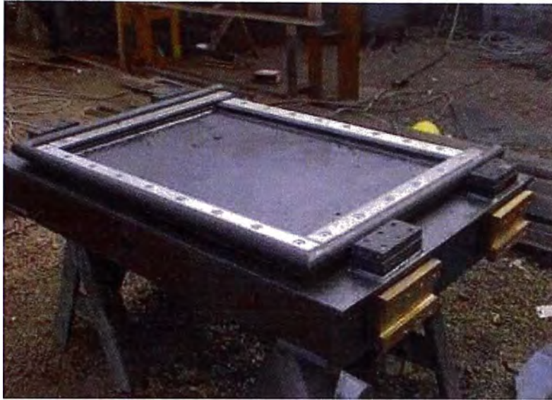
Figura 2.15 Ensamble de sellos en compuerta plana deslizante
