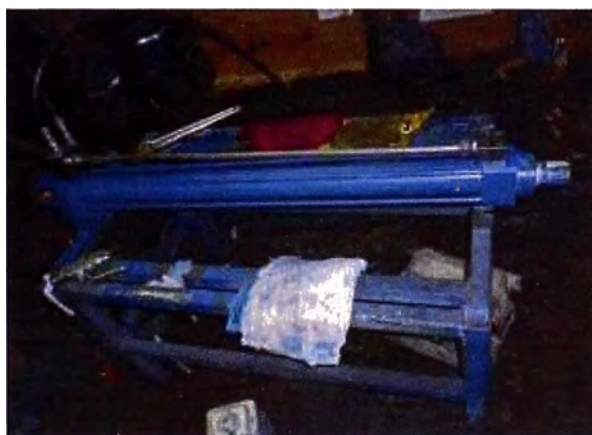
Figura 2.20 Pruebas FAT de cilindros hidráulicos en taller de subcontratista
