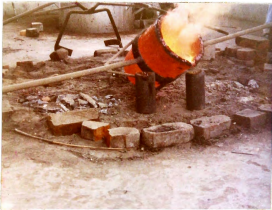
COLANDO PROBETAS PARA ENSAYOS FISICOS
