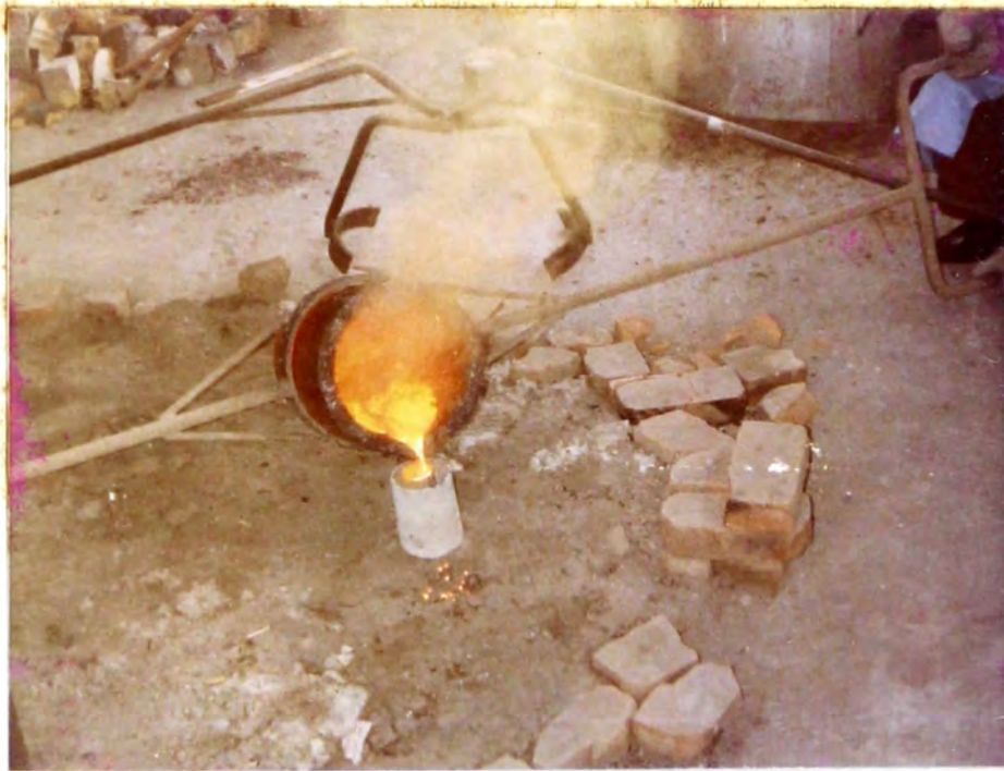
COLANDO MUESTRA PARA CONOCER GRADO DE DESOXIDACION
