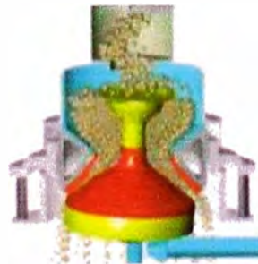
Figura 7: Reducción en Chancado Cónica
