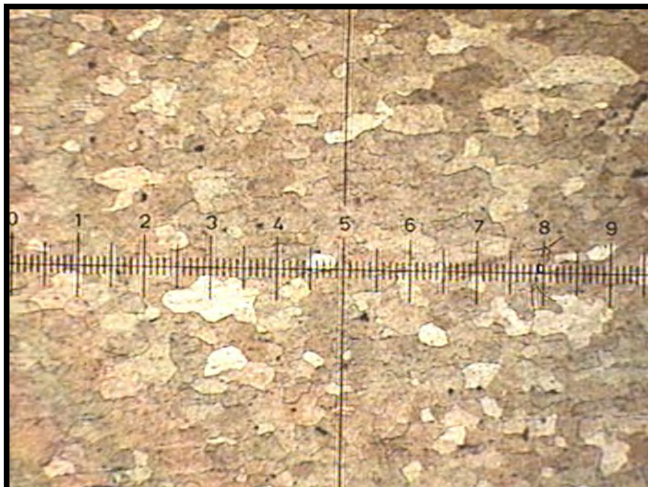
Figura 2.14 Recristalización a 500°C y tiempo 1 hora.32X
