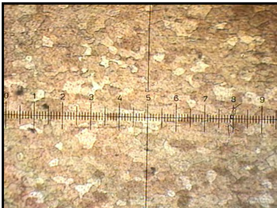
Figura 2.15 Recristalización a 500°C y tiempo 2 horas.32X
