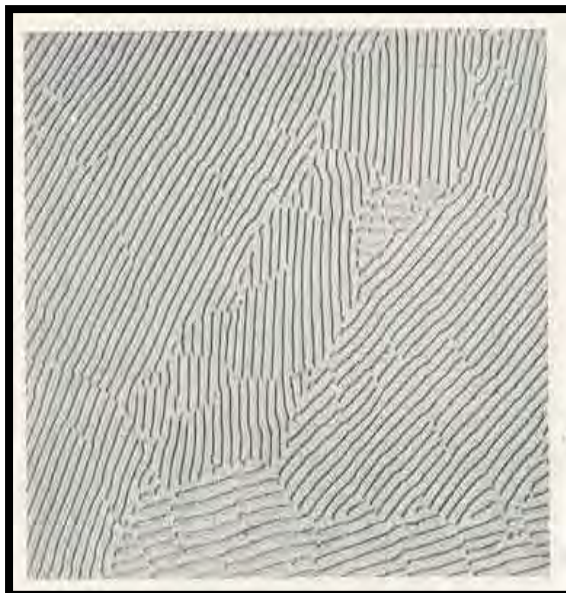
Figura 1.14 Lamelas en una aleación eutéctica Al-Cu solidificada unidireccionalmente (MetalsHandbook 8th edition, 1979, Vol 8)
