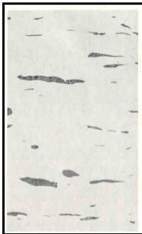
Figura 1.13 Inclusiones alargadas de sulfuros en un acero inoxidable 303 corte libre. 220X. (MetalsHandbook 8th edition, 1979, Vol 8)
