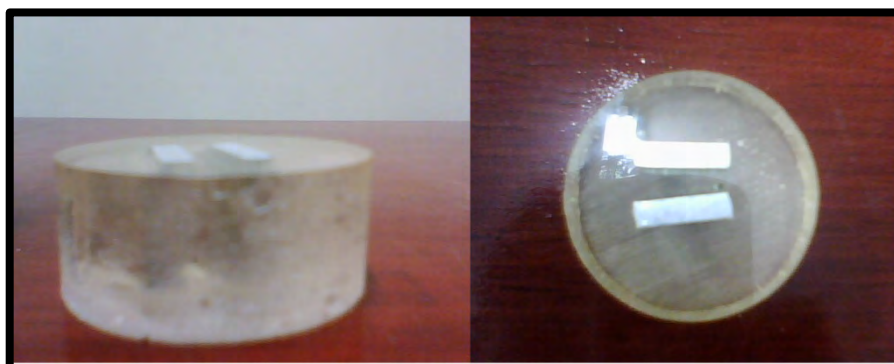
Figura 2.5 Placas de aluminio introducidas en una briqueta
