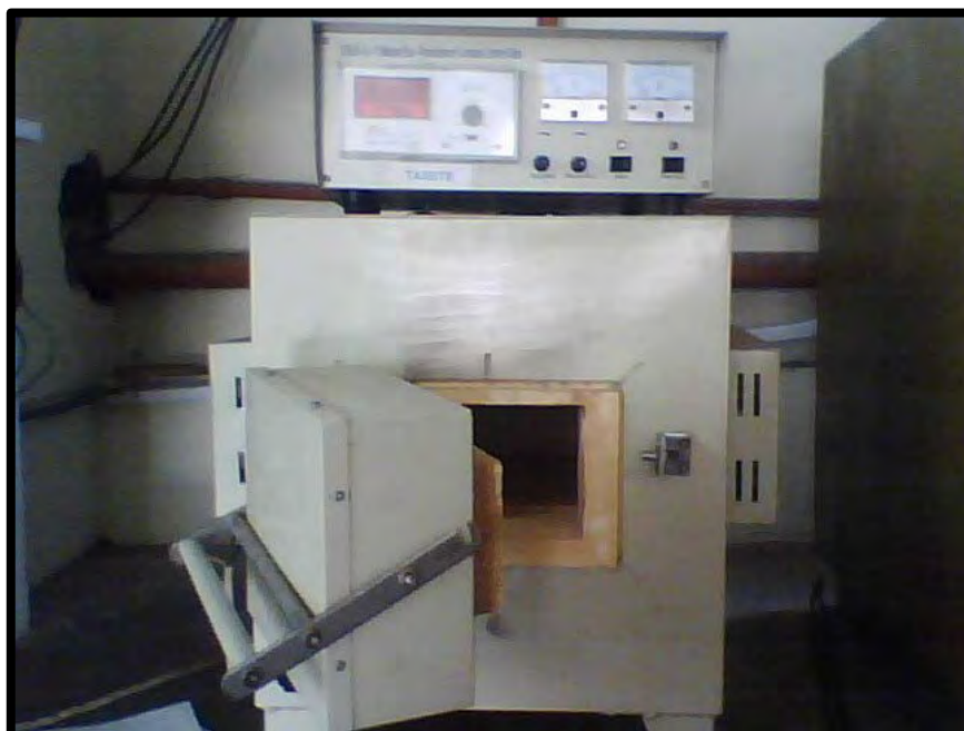
Figura 2.2 Horno De Recocido
