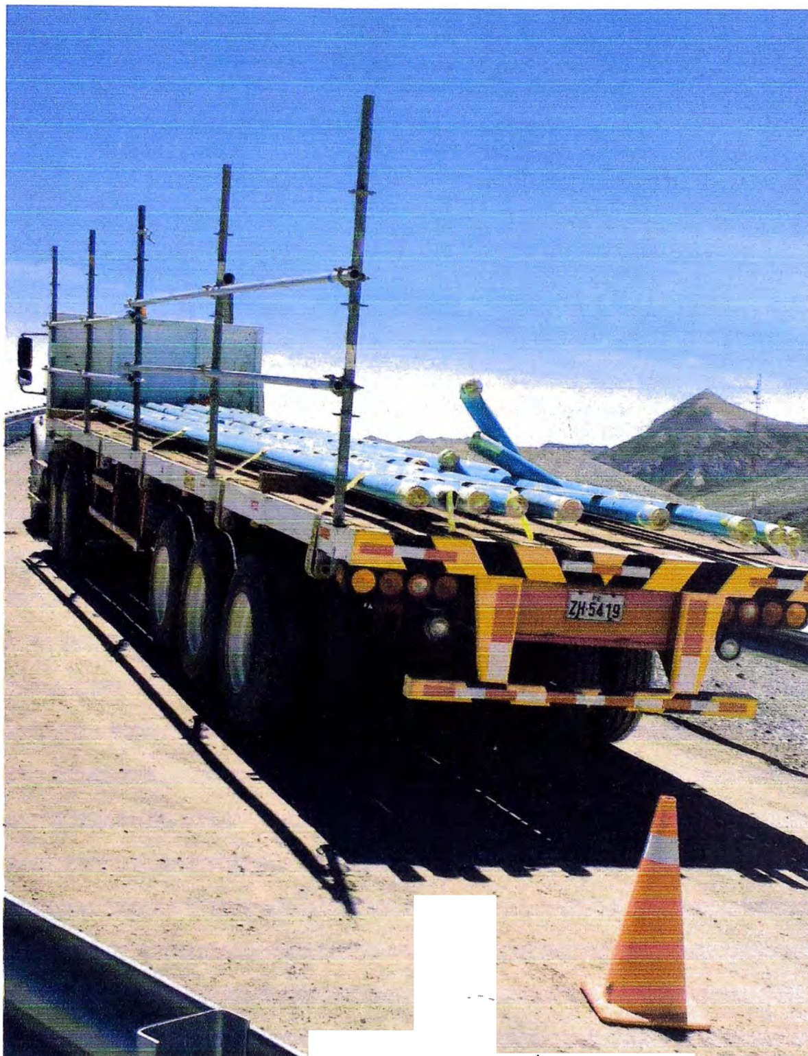
Figura 2.6: Ejemplo de traslado de tuberías de acero al carbono con camión plataforma en planta concentradora Toromocho
