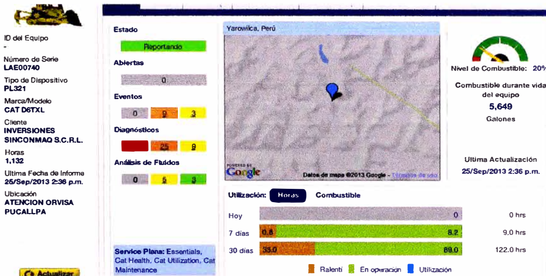
Figura 5.12 Imagen del control total, ubicación, operación, rendimiento, alertas y nivel de combustible
