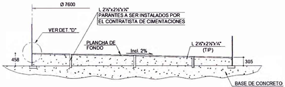
Imagen 20. Detalle del fondo dentro del tanque.
