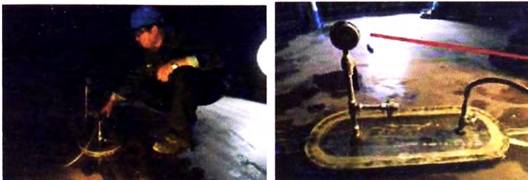
Imagen 35. Prueba de vacío del fondo
