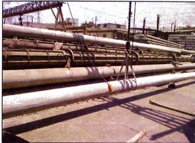
Figura N° 4.1: Postes de concreto CAC.
