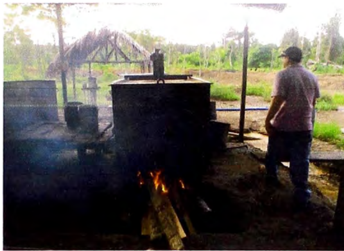
Fig. N° 5.18 Preclarificación usando leña
