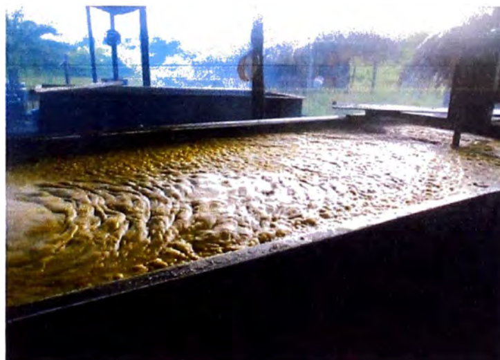
Fig. N° 5.19 Clarificación por decantación y purga
