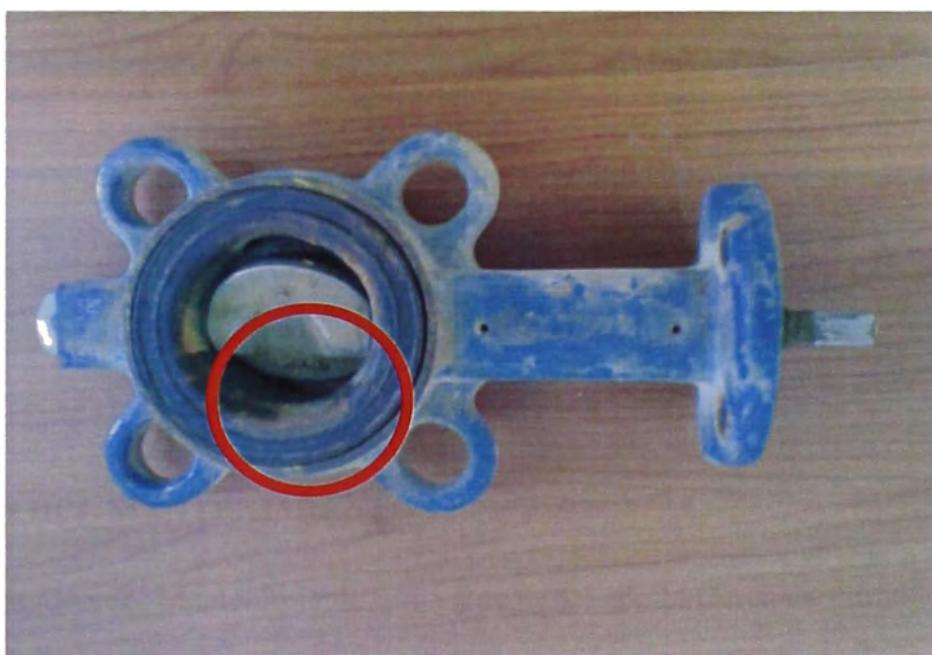
Ilustración 3.11 - Válvula de paso rota
