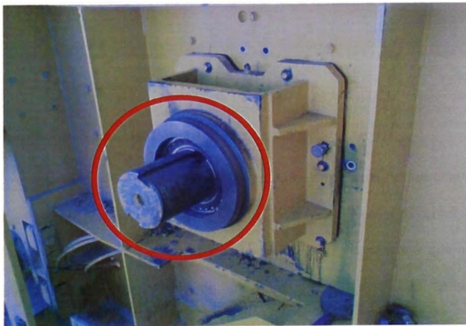
Ilustración 3.10 - Vista externa del apoyo del eje del Mezclador
