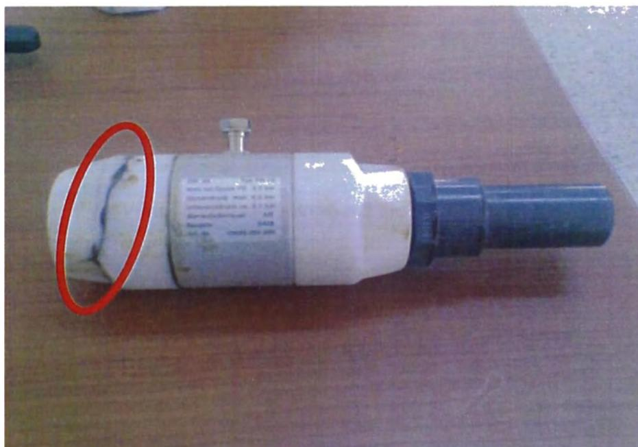
Ilustración 3.8 - Válvula dosificadora rota
