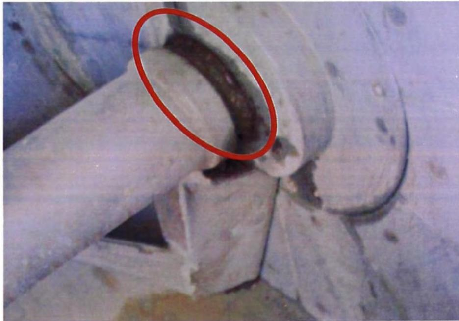
Ilustración 3.9 - Vista interna del apoyo del eje del Mezclador
