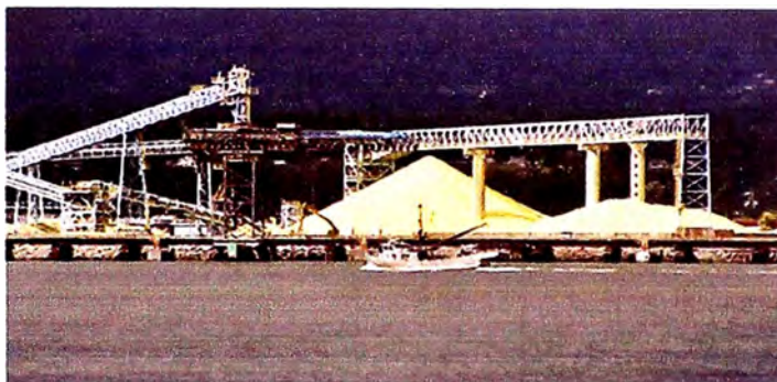
Figura 4.2: Ángulo de reposo estático
